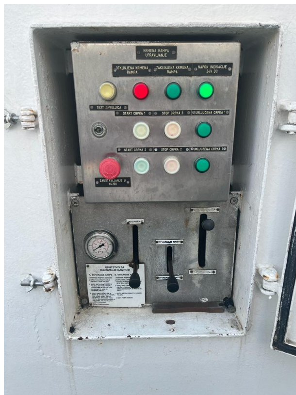
Slika 14. Upravljanje rampom na trajektu “JURAJ DALMATINAC”
