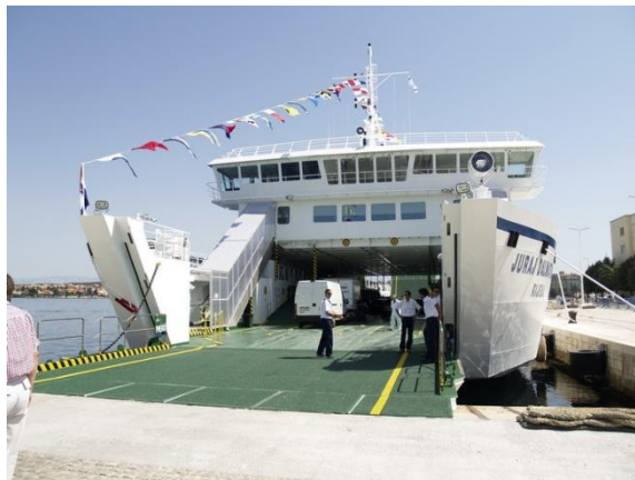
Slika 13. Rampa na trajektu "Juraj Dalmatinac" [7]
