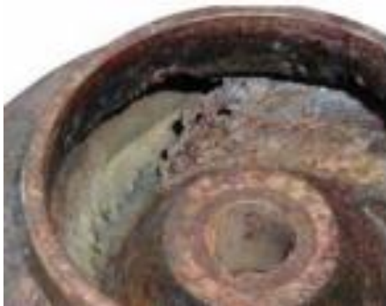
Slika 9. Kavitacijska oštećenje rotora centrifugalnih pumpi [4]
