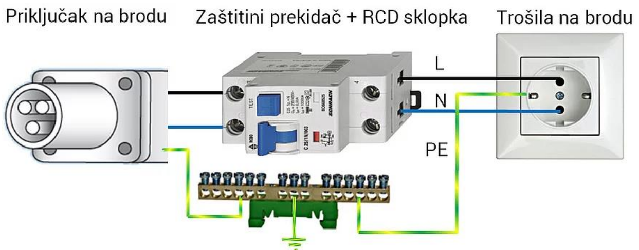
Slika 8. Prikaz priključka struje na brodu [19]
