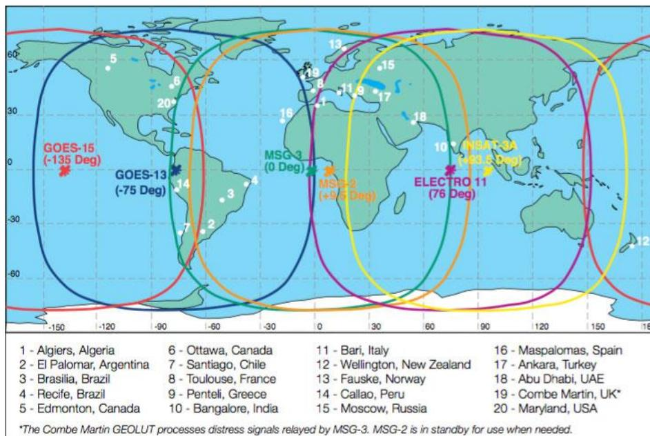
Slika 11. Područje pokrivanja GEOSAR satelita i GEOLUT-a [2]
