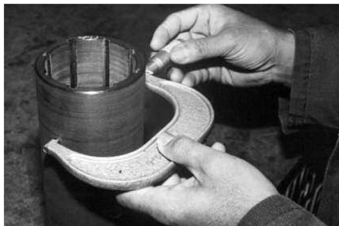
Slika 21. Mjerenje promjera ležaja [10]
