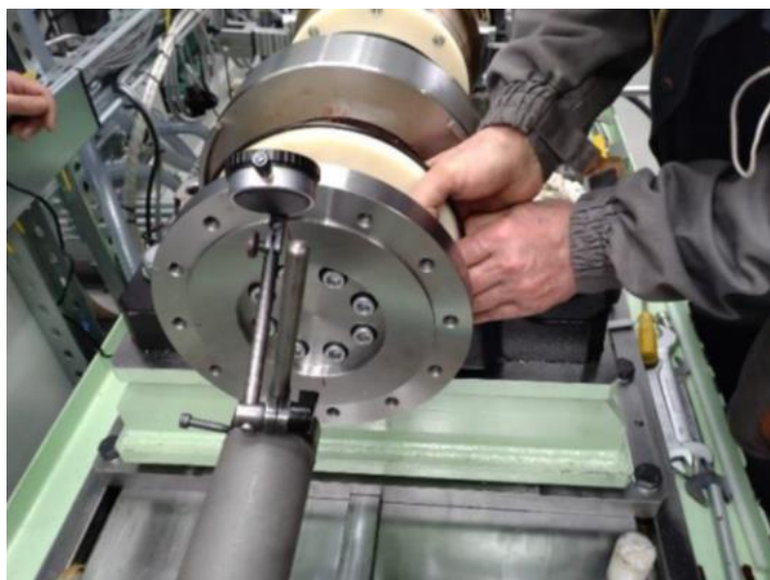
Slika 33. Centriranje vratila i kućišta ležaja [12]
