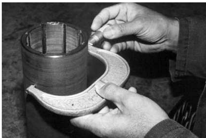
Slika 21. Mjerenje promjera ležaja [10]
