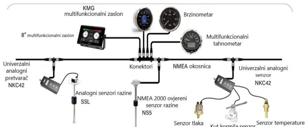
Slika 29. NMEA mrežni integrirani sustav [28]
