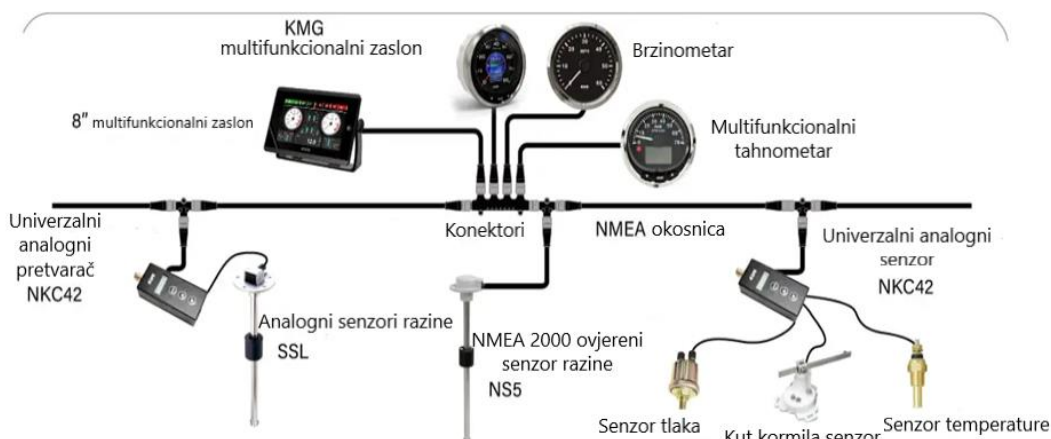
Slika 29. NMEA mrežni integrirani sustav [28]
