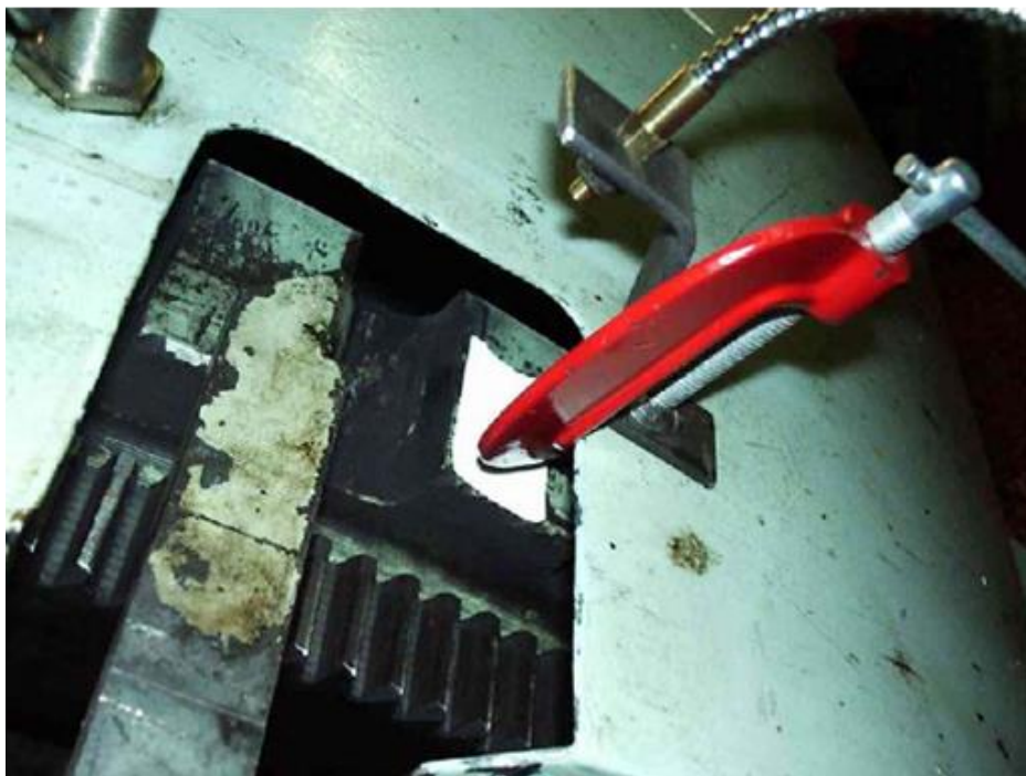
Slika 39. Optički pick-up davač brzine vrtnje [30]
