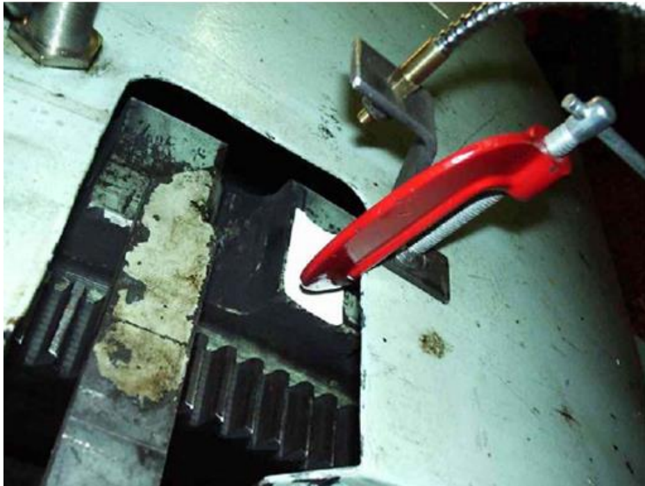
Slika 39. Optički pick-up davač brzine vrtnje [30]
