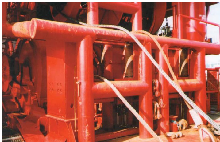
Slika 31. Čelično uže namotano na bubanj AHTS broda [18]
