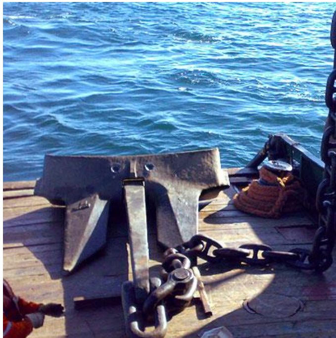
Slika 32. Sidreni lanac s prečkom [31]
