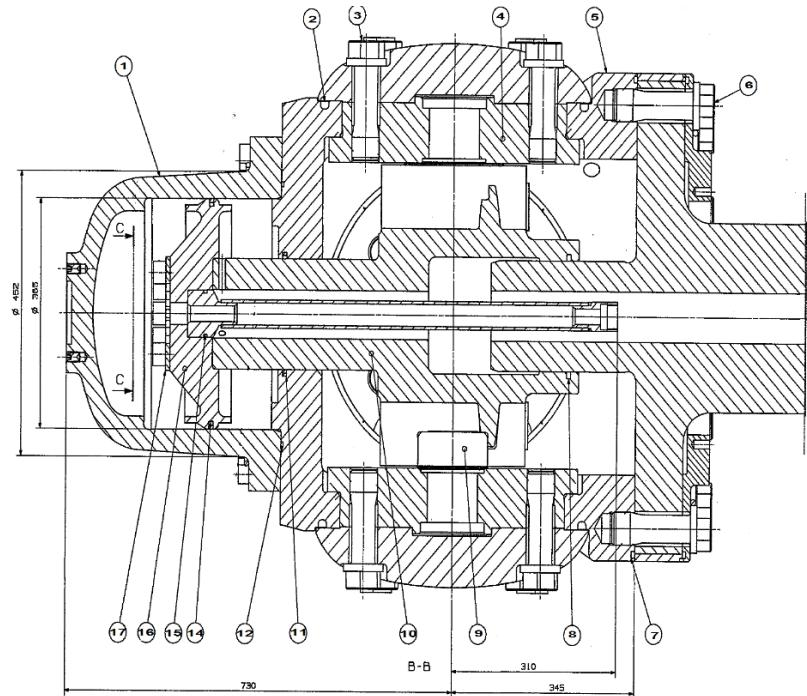
**Slika 41. Glavne komponente servomotora za promjenu uspona krila [42]**
