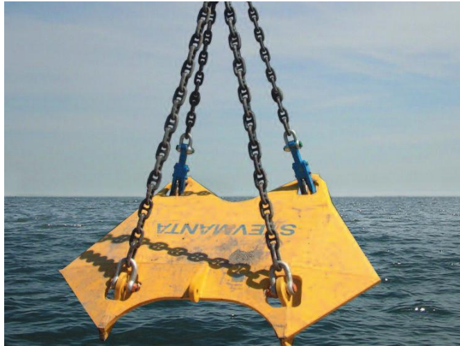
Slika 29. Vertikalno opterećeno sidro [29]
