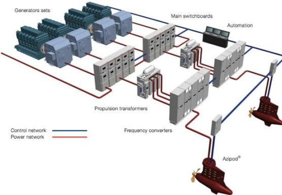
**Slika 14. Plan električne instalacije Azipod propulzije [13]**
