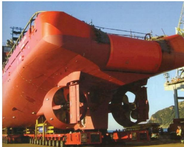
**Slika 19. Podvodni dio krmenog dijela broda [18]**
