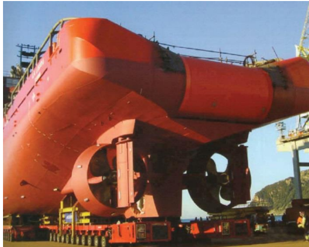
Slika 19. Podvodni dio krmenog dijela broda [18]
