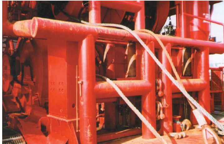
Slika 31. Čelično uže namotano na bubanj AHTS broda [18]
