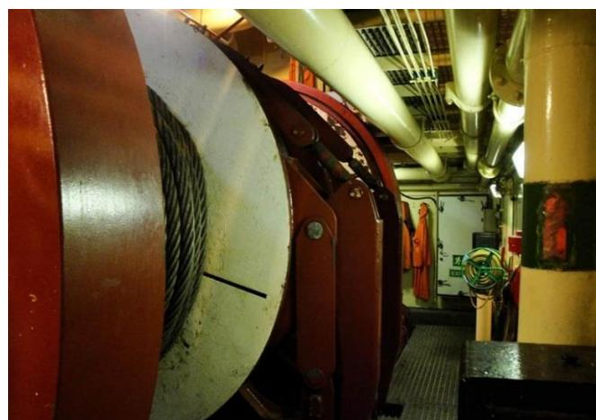
Slika 24. Kočnica na radnom vitlu za podizanje sidara [24]
