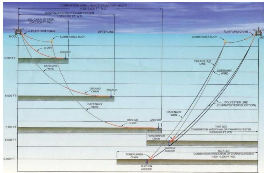
**Slika 30. načini povezivanja platformi na pojedinim dubinama [27]**
