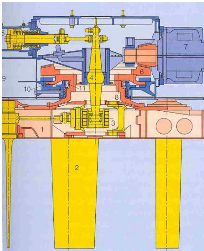
**Slika 15. Voith-Schneider propulzor [15]**
