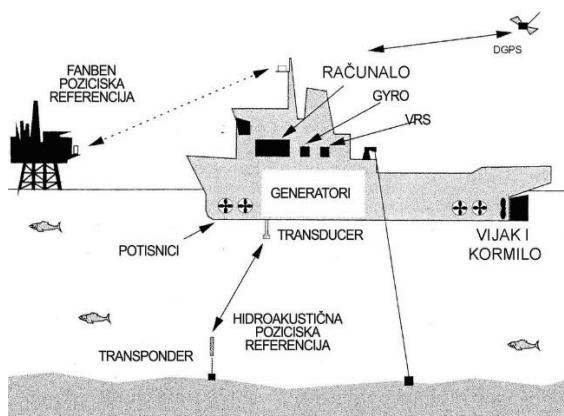
Slika 35. Sustav dinamičkog pozicioniranja [35]
