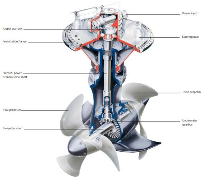
**Slika 8. Schottel propulzijska jedinica s dva vijka [9]**
