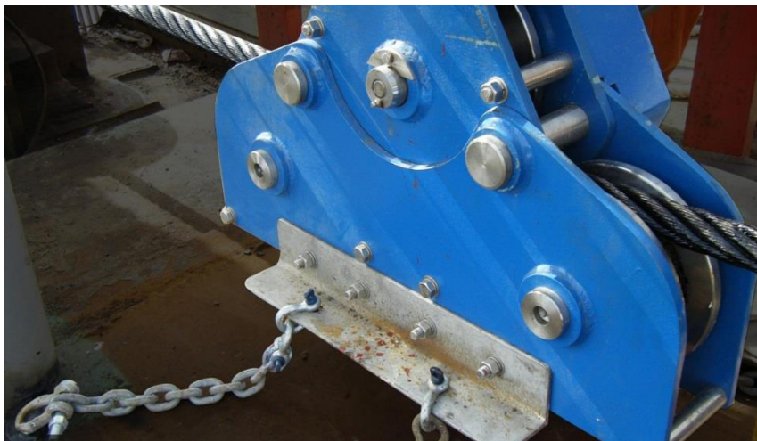
Slika 25. Uređaj za mjerenje sile u užetu [25]
