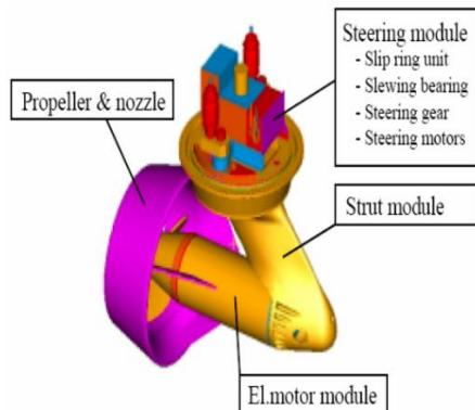
**Slika 13. Glavne komponente Azipod propulzije [11]**
