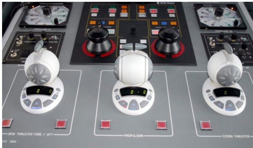
Slika 47. Rolls-Royce Helicon X3 sustav upravljanja propulzijom [40]
