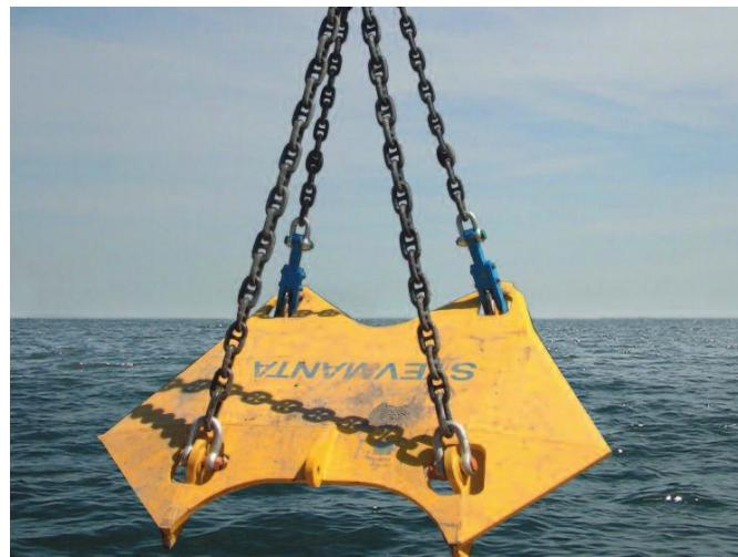
**Slika 29. Vertikalno opterećeno sidro [29]**
