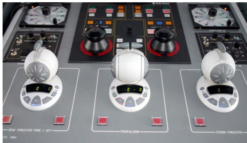
Slika 47. Rolls-Royce Helicon X3 sustav upravljanja propulzijom [40]
