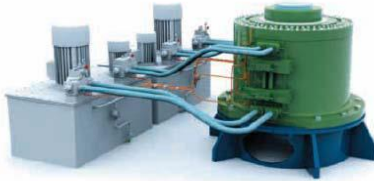
Slika 15. Krilni uređaj sa pumpama[11]
