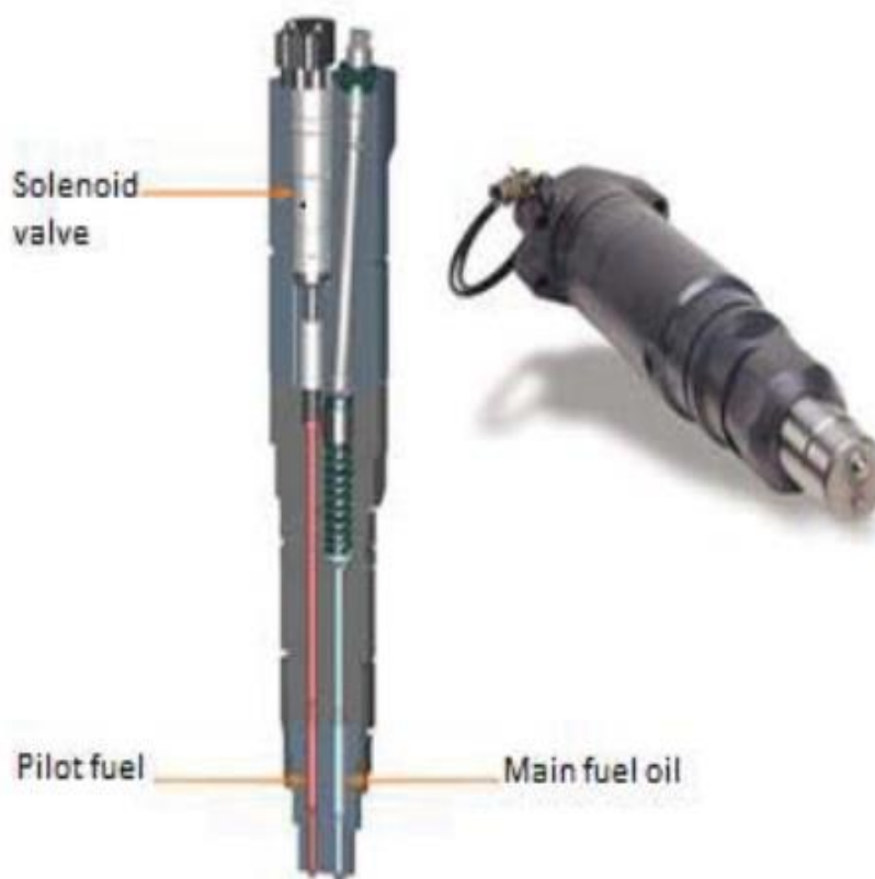
Slika 14. Ubrizgač dizela na DF motorima [9]
