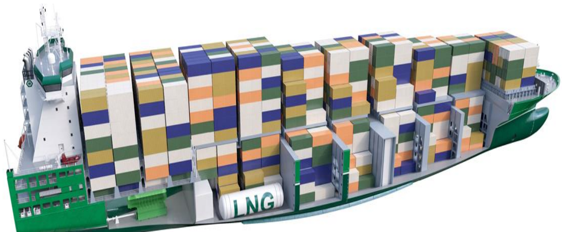
Slika 35. DNV GL-ov kontejner sa LNG pogonom [20]
