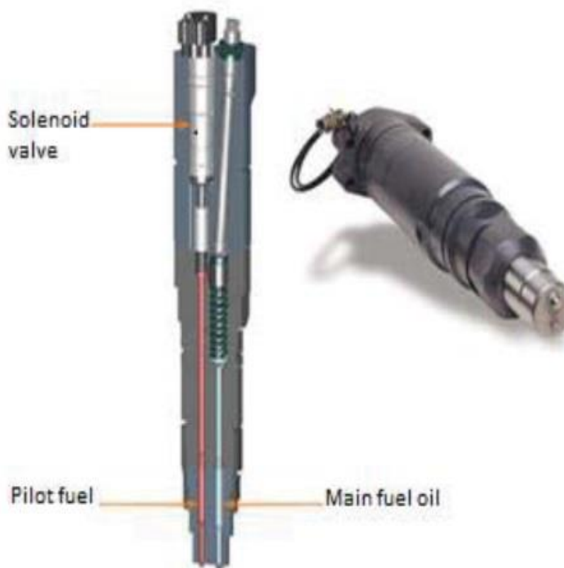
Slika 14. Ubrizgač dizela na DF motorima [9]
