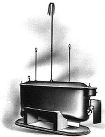
Slika 15. Radioupravljeni model broda [1]
