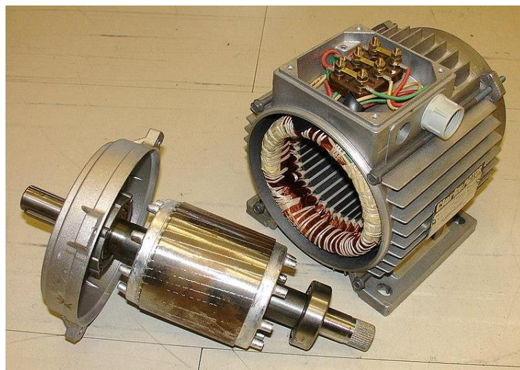
Slika 13. Rotor (dolje lijevo) i stator (gore desno) induksijskog motora. [3]
