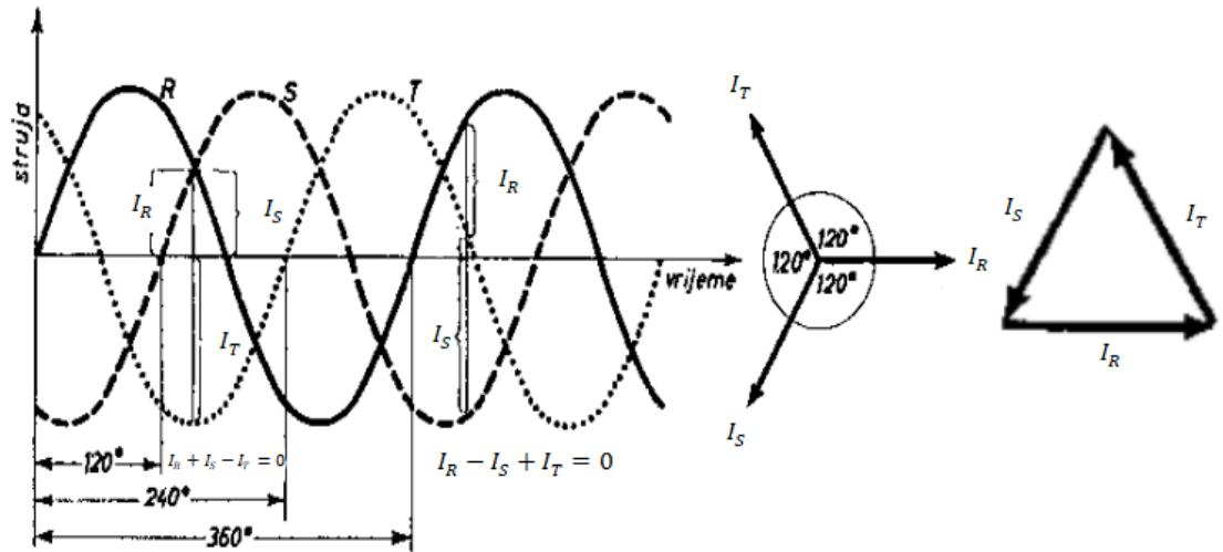
Slika 7. Graf ovisnosti struje o vremenu trofaznog sustava [9]
