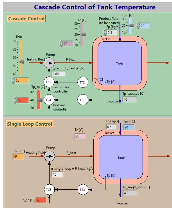
Slika 6.:Temperatura tekućine za zagrijavanje postavljena na  $55^{\circ}\text{C}$
