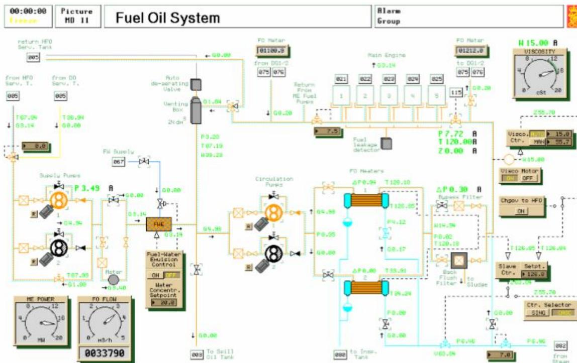
Slika 12.: Blok shema dobave goriva glavnog motora na supertankeru ERS L11
