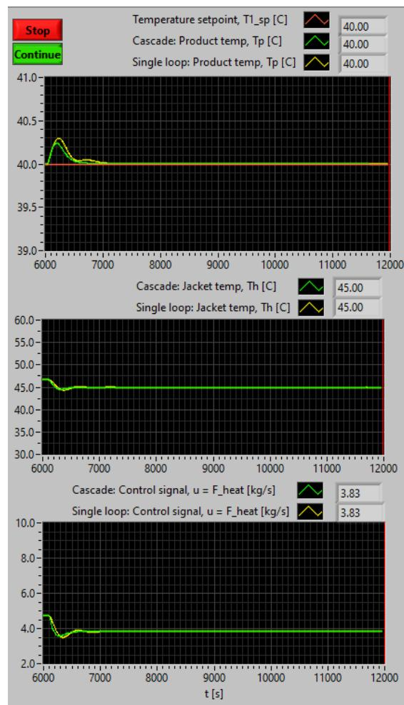
Slika 11.:Rezultati simulacije provedene pri postavljenoj temperaturi ulazne tekućine na  $25^{\circ}\text{C}$
