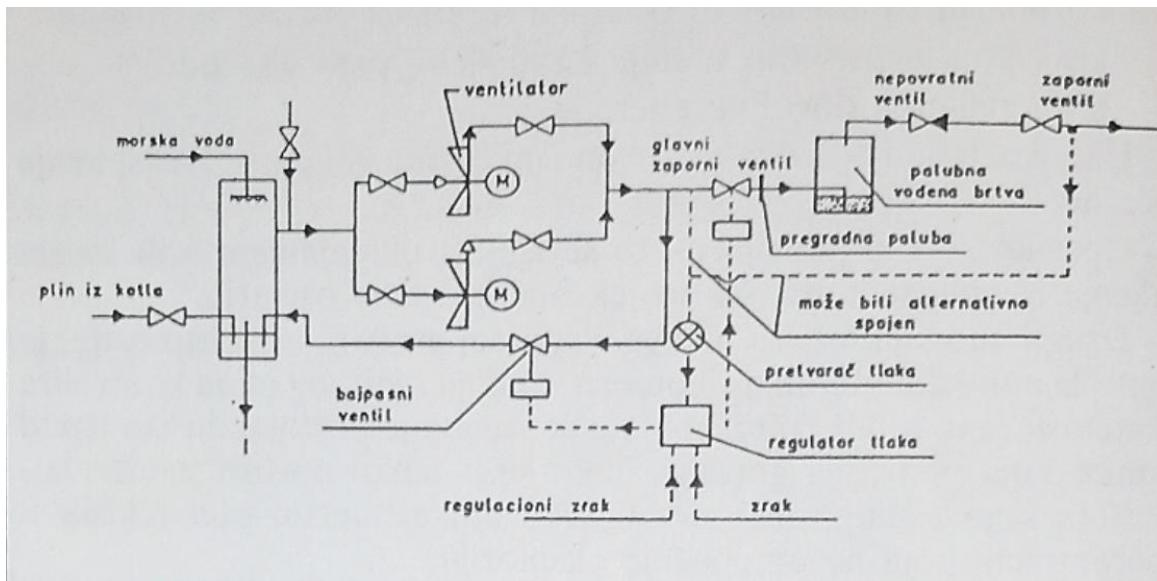
**Slika 8. Shematski prikaz sustava uređaja za inertni plin [1]**
