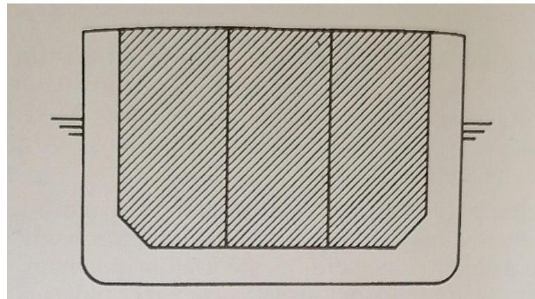
**Slika 3. Shematski prikaz konstrukcije tankera s dvostrukim trupom [1]**
