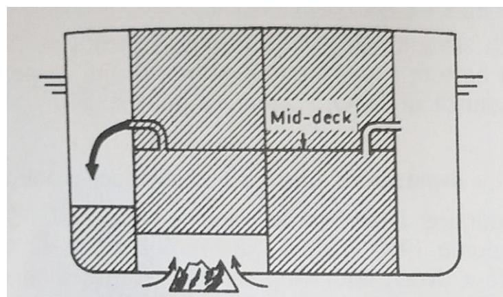
Slika 4. Shematski prikaz konstrukcije tankera sa središnjom palubom [1]
