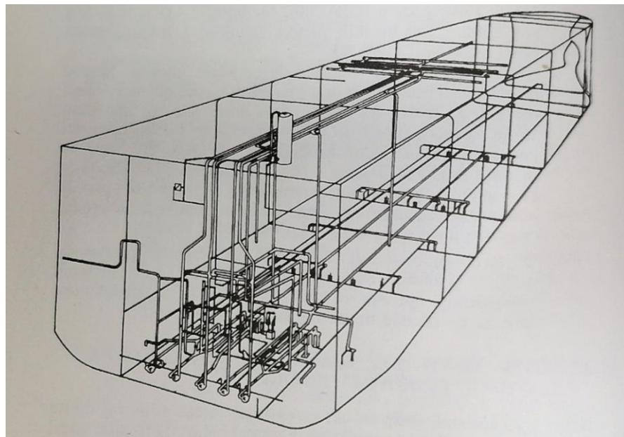
**Slika 10. Sustav cjevovoda i raspored tankova na VLCC-u [1]**
