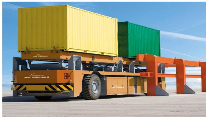
**Slika 9. Automatizirano vozilo za prijevoz kontejnera (AGV) [14]**
