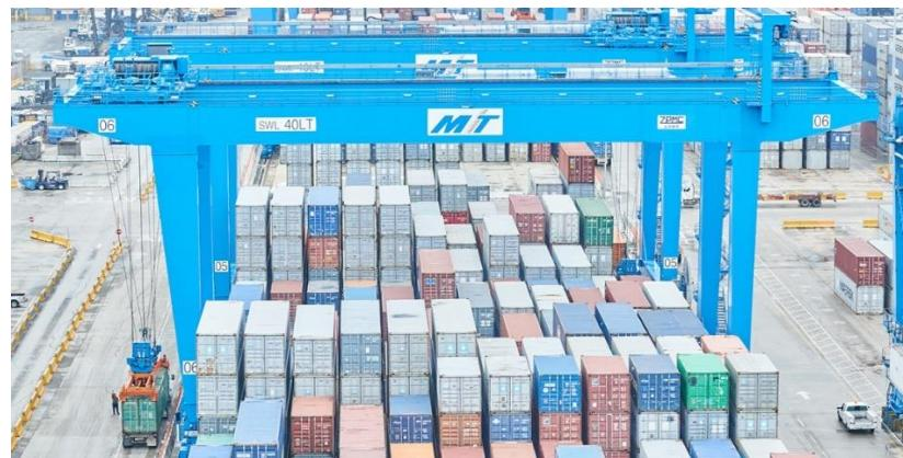
**Slika 11. Bočno opsluživana automatizirana pokretna dizalica na kolosjeku sa bočnim nosačem (CARMG) [39]**
