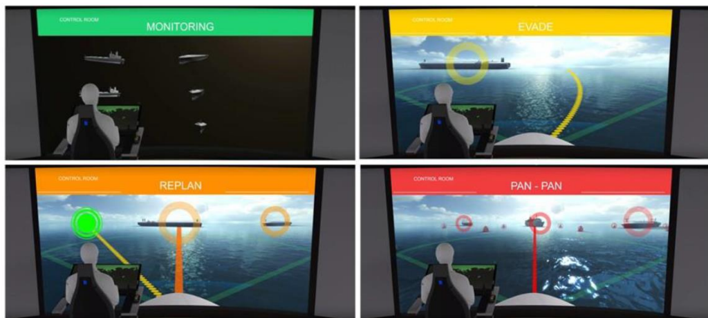
Slika 3. Različite razine uključenosti operatera u navigaciju autonomnog broda [15]
