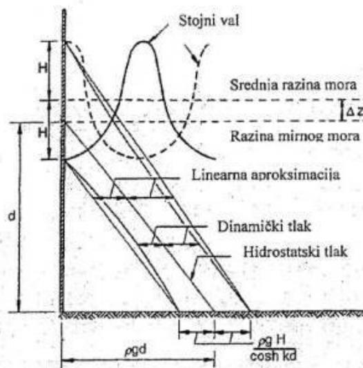
**Slika 7. Raspodjele tlaka stojnog vala na vertikalnom zidu [12]**
