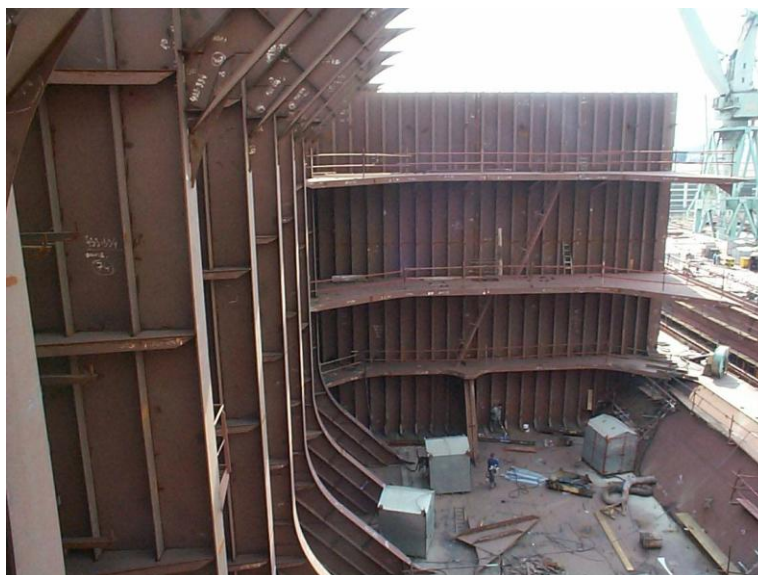
Slika 26. Poprečne i uzdužne pregrade; prema [6]
