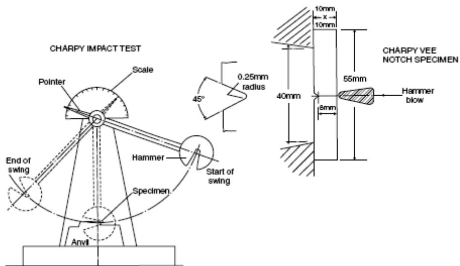
**Slika 8. Charpyjev test udarne žilavosti; prema [6]**
