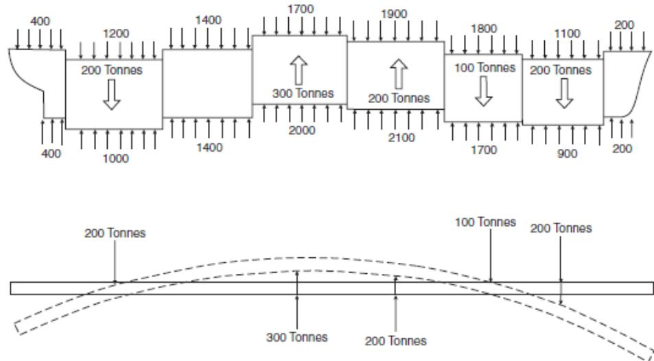
Slika 9. Vertikalna i horizontalna opterećenja; prema [7]
