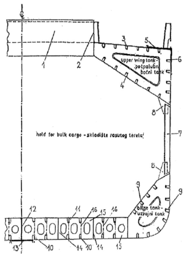
Slika 19. Mješoviti sustav gradnje; prema [6]
