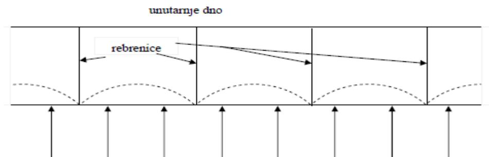
**Slika 12. Lokalna savijanja oplate dna zbog tlaka vode; prema [6]**
