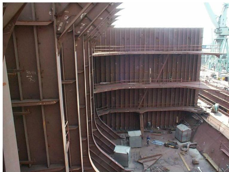
**Slika 26. Poprečne i uzdužne pregrade; prema [6]**
