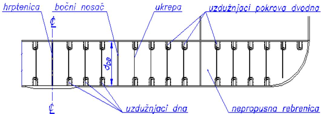
Slika 23. Poprečni sustav ukrepljenja dvostrukog dna; prema [6]
