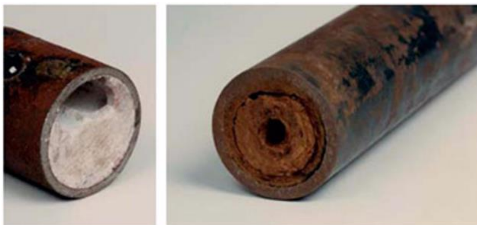
Slika 7. Nakupina kamenca unutar cijevi [10]
