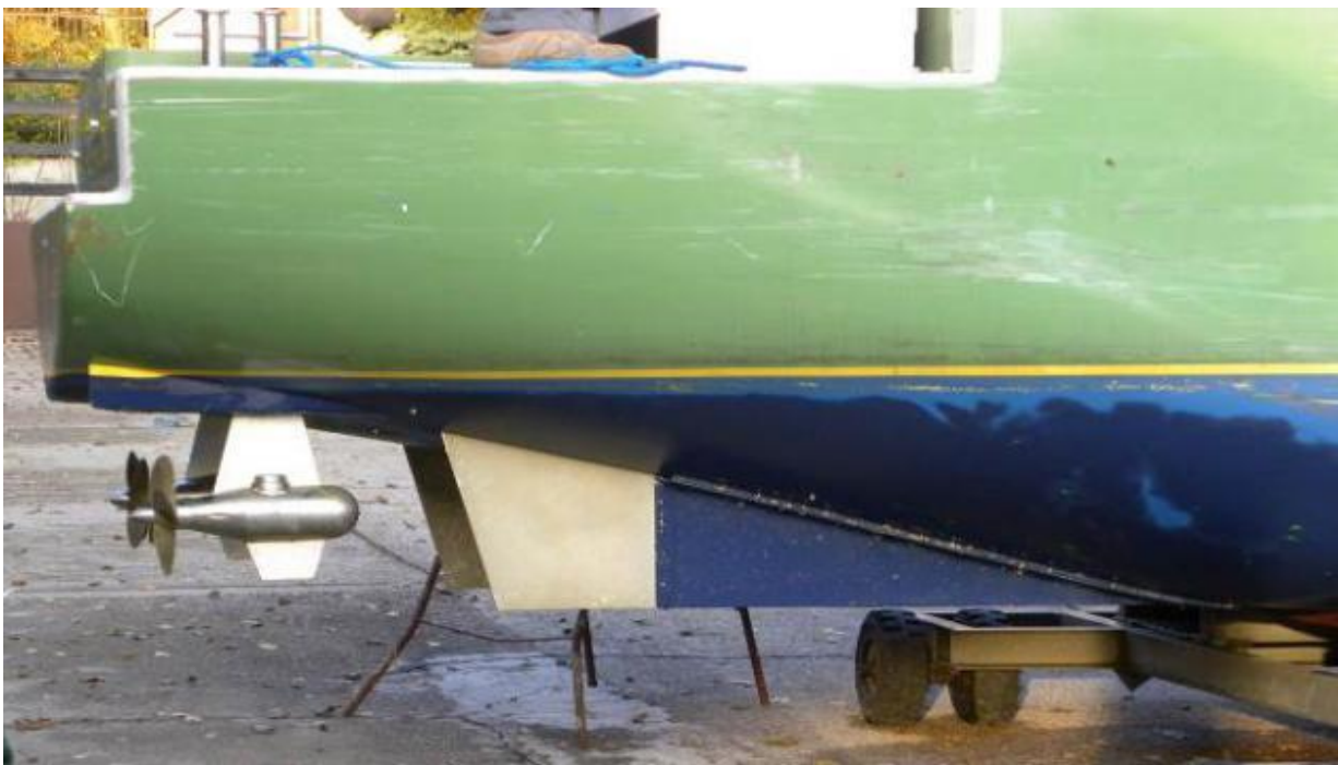
Slika 18. Model LNG tankera opremljen s dva azipoda [3]
