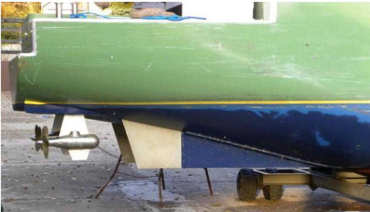
Slika 18. Model LNG tankera opremljen s dva azipoda [3]
