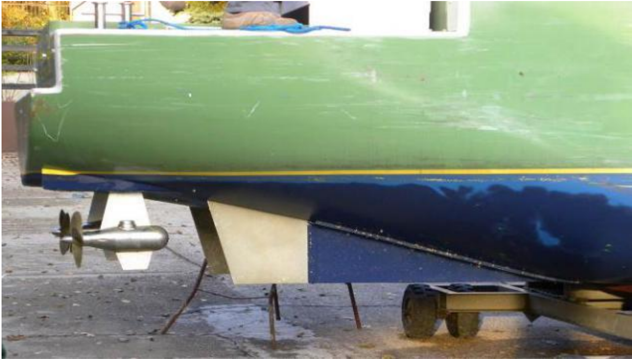
Slika 18. Model LNG tankera opremljen s dva azipoda [3]
