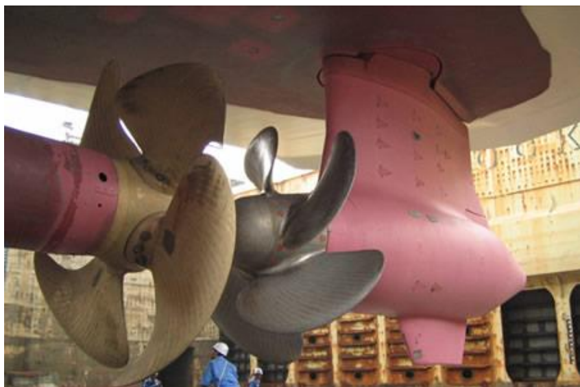
Slika 9. Prikaz kontra rotirajućih propelera [15]
