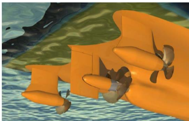
Slika 10. Primjer centralnog vijka s dva wing azipoda [5]
