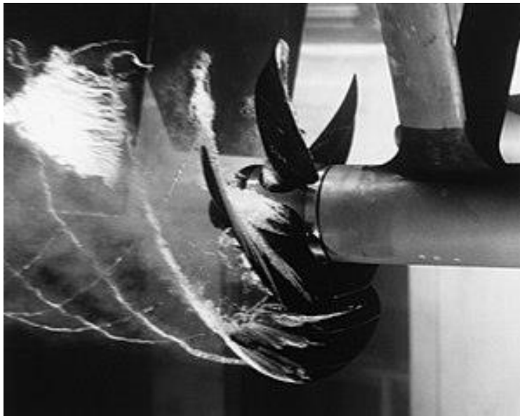
Slika 6. Brodski vijak na kojem se pojavljuje kavitacija [32]
