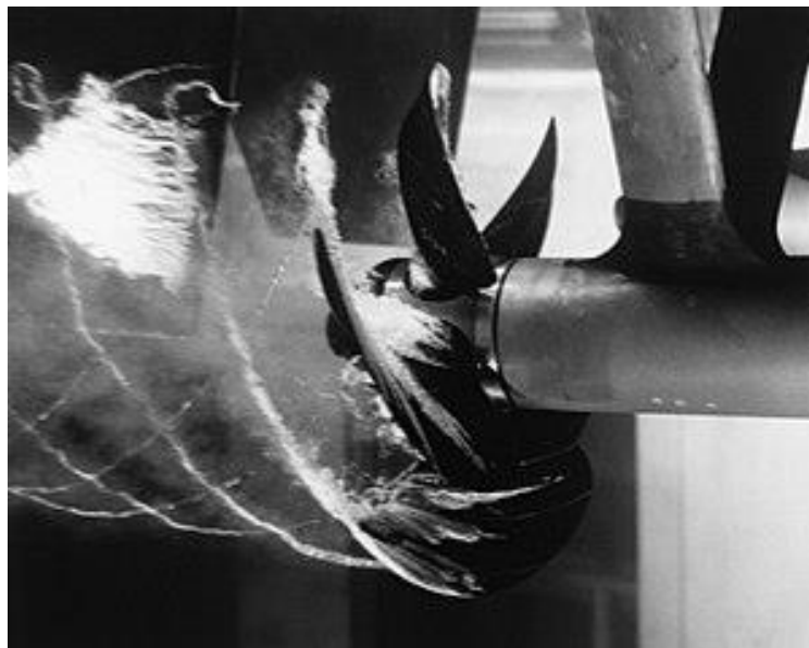
Slika 6. Brodski vijak na kojem se pojavljuje kavitacija [32]
