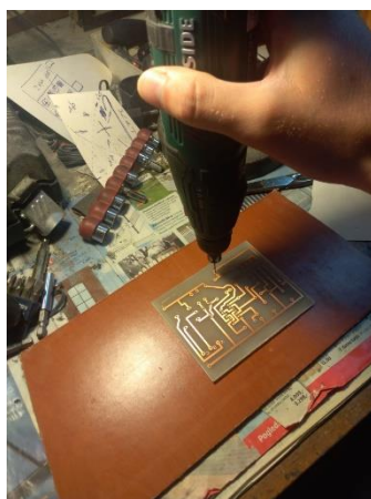
Slika 26 Bušenje rupa na pločici
