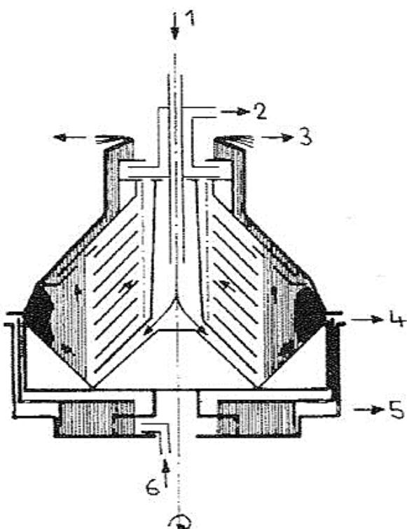
1-napajanje nečistog ulja/goriva; 2-izlaz očišćenog ulja/goriva; 3-izlaz nečiste vode; 4-izbacivanje taloga; 5-izlaz vode za upravljanje; 6 – napajanje vodom za upravljanje
