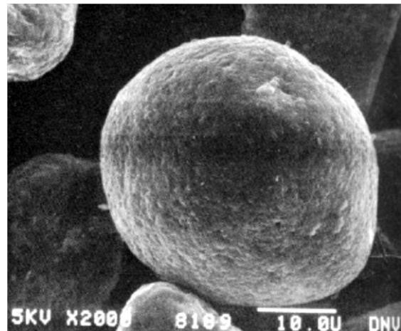
**Slika 1. Čestica katalizatora promjera  $40 \mu\text{m}$  izdvojena klarifikatorom [3]**
