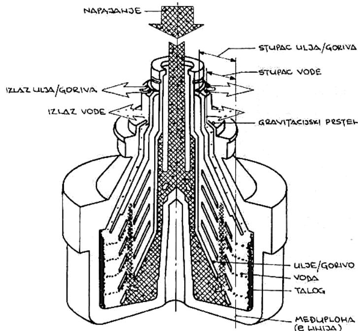
**Slika 6. Bubanj centrifugalnog čistioca, talog se zadržava [1]**
