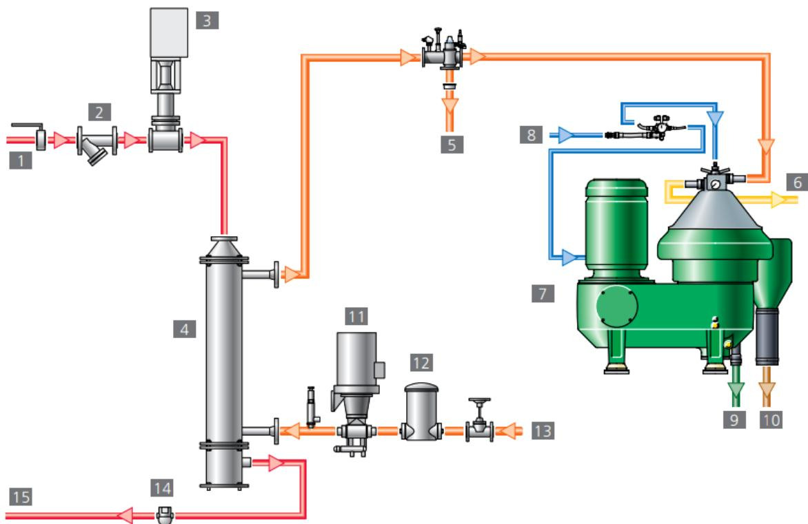
1 – Para; 2 – Odvajač kapljica vode; 3 – Ventil otvorenosti pare; 4 – Grijač goriva ; 5 – Povrat; 6 – Čisto gorivo ; 7 – Centrigugalni čistioč; 8 – Operativna voda ; 9 – Izlaz nečiste vode; 10 – Izbacivanje taloga; 11 – Napojna pumpa; 12 – Filter ; 13 – Dovod ulja; 14 – Kondenzator;
