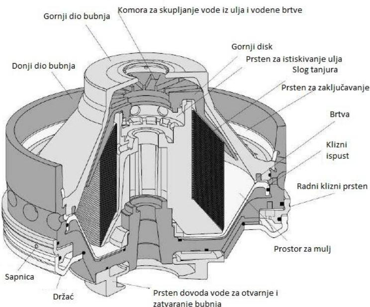
**Slika 8. Bubanj centrifugalnog samočistioča sa sapnicom [8]**
