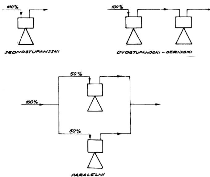
**Slika 25. Shema alternativnog rada samočistioca za teška goriva [1]**
