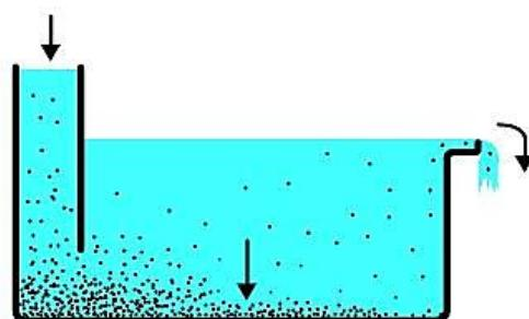
**Slika 3. Prikaz kontinuiranog gravitacijskog taloženja [3]**
