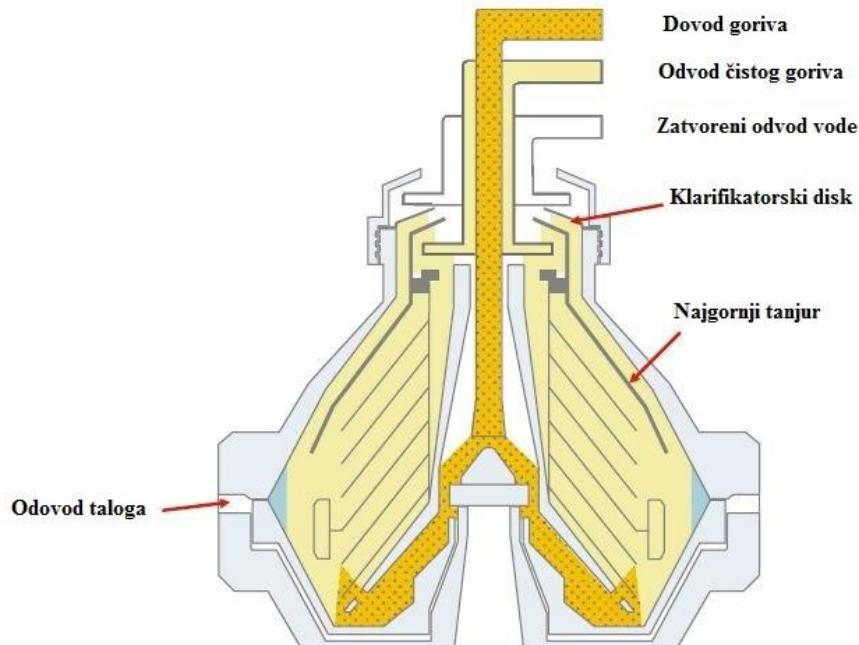
Slika 19. Presjek klarifikatora [6]
