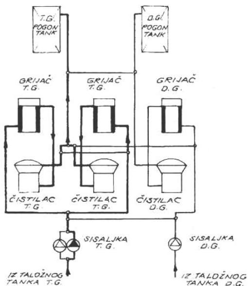
**Slika 24. Shema jednostupanjskog paralelnog sustava pročišćavanja [4]**
