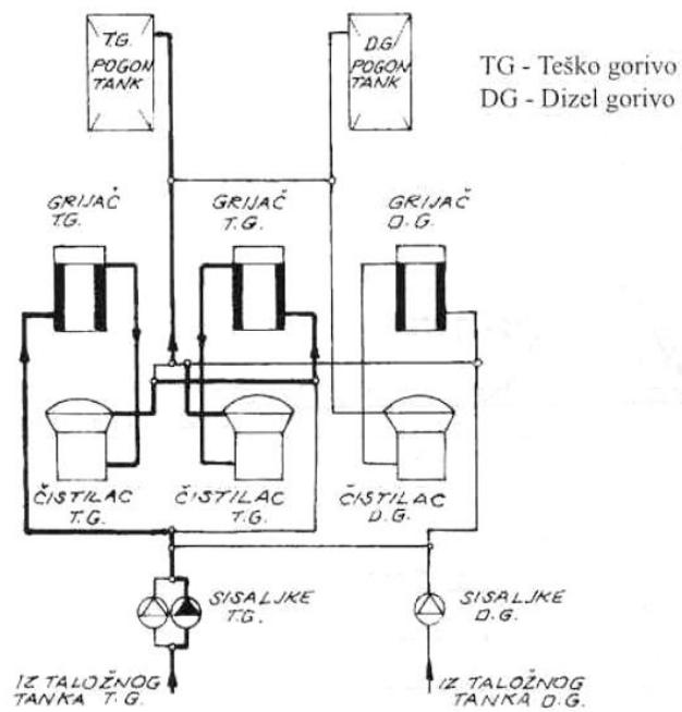
**Slika 23. Shema dvostupanjskog serijskog sustava pročišćavanja [1]**
