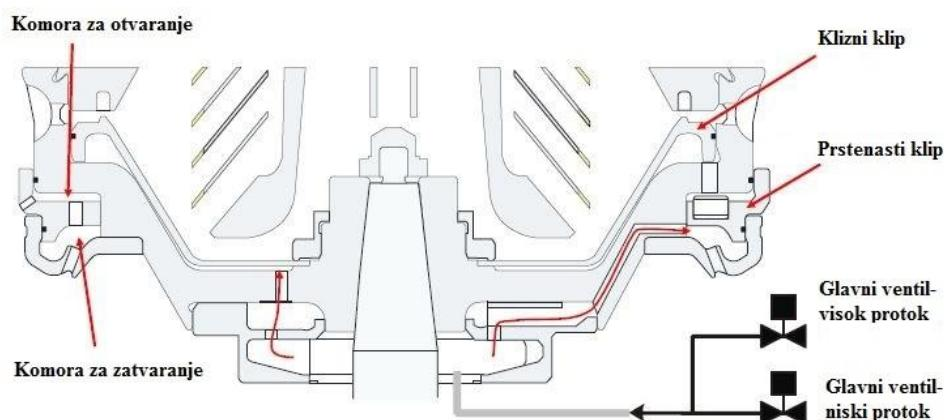
**Slika 33. Mehanizam za otvaranje i zatvaranje bubnja [10]**
