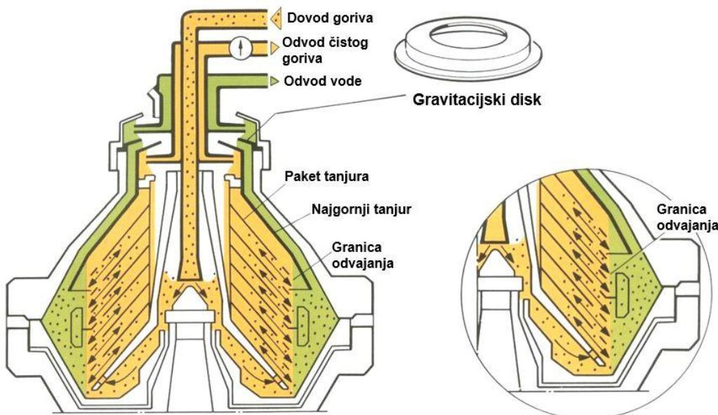
Slika 18. Presjek purifikatora [3]
