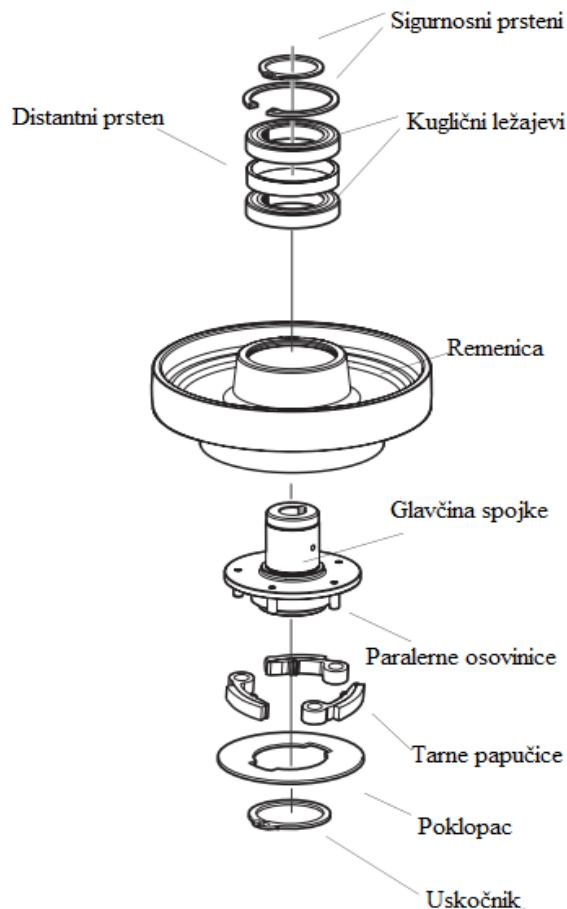
**Slika 40. Sklop tarne spojke centrifugalnog čistioca [7]**
