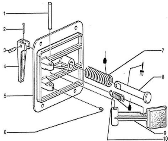
1 Cilindrični osnjak; 2 Rascjepka; 3 Cilindrični osnjak s rupom; 4 Ručka; 5 Poklopac; 6 Osiguravajući vijak;
