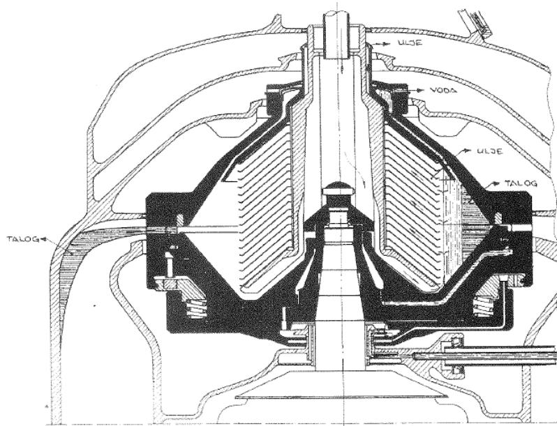
**Slika 7. Bubanj centrifugalnog čistioča sa rasporom [1]**
