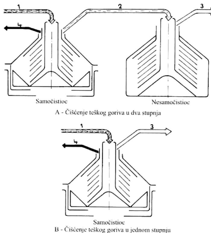
1- napajanje nečistog goriva; 2- Izlaz djelomično očišćenog goriva 3- Izlaz onečišćenog goriva; 4- Izlaz vode
