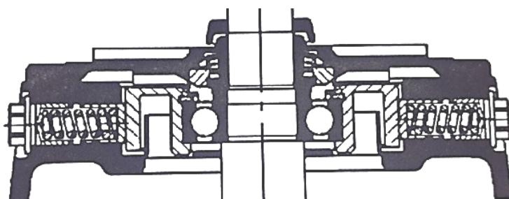
Slika 42. Anti vibracijsko kućište ležaja vertikalne osovine [6]
