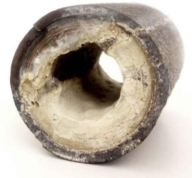
**Slika 22. Prikaz istaloženog kamenca u cijevi [23]**
