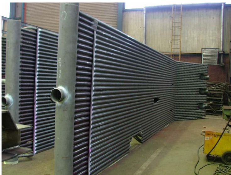
Slika 18. Membranski cijevni zid sa komorom [11]
