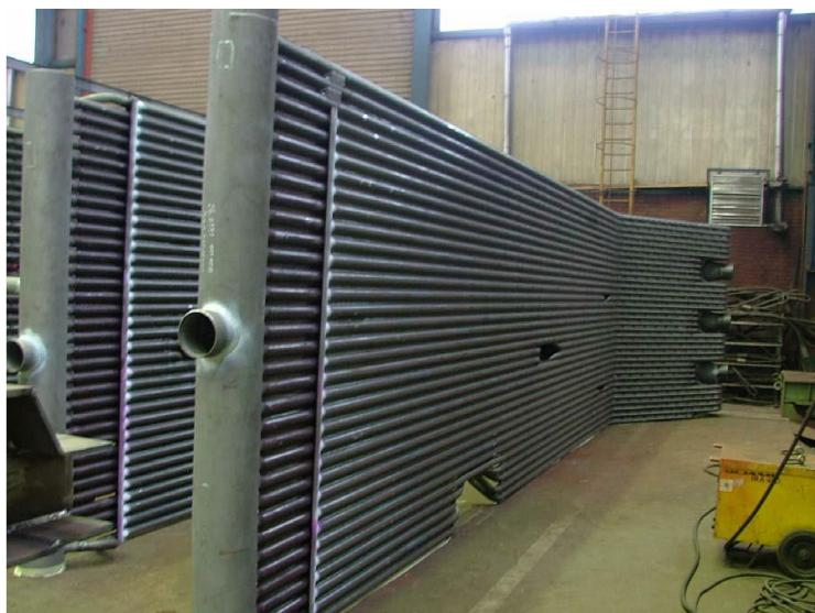
**Slika 18. Membranski cijevni zid sa komorom [11]**
