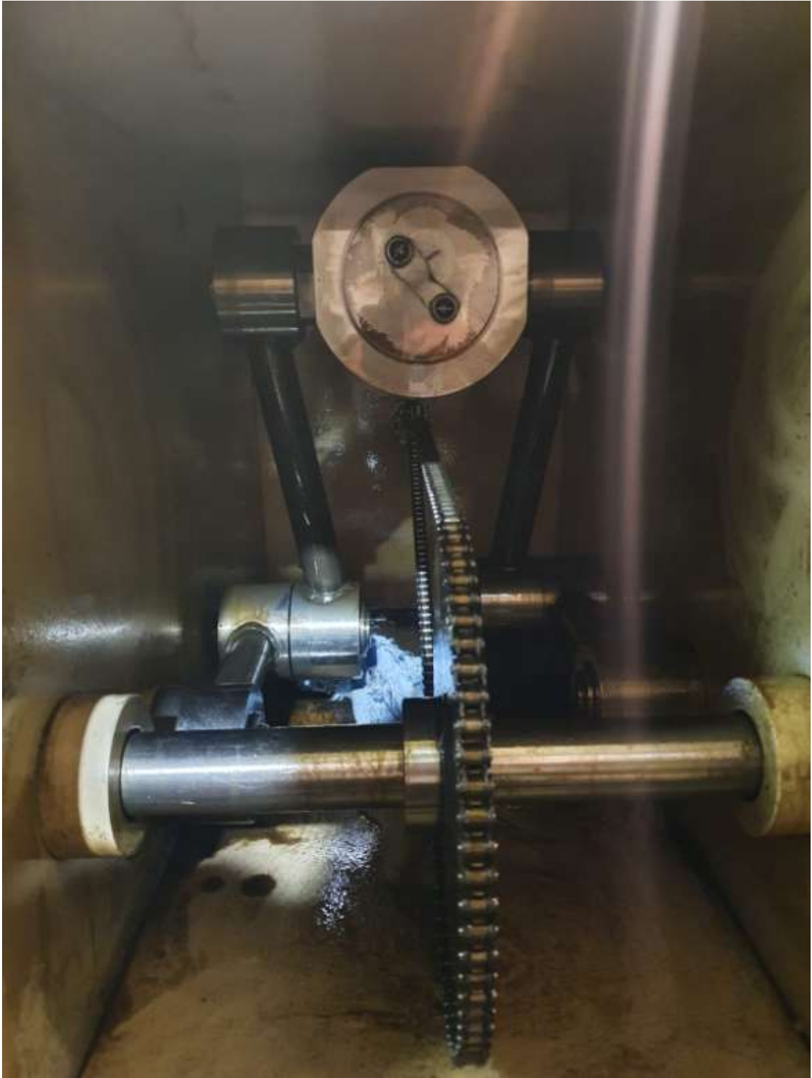
Slika 24. Unutrašnjost uređaja za dobavu ulja s broda Empress of the seas [15]
