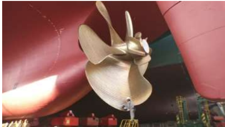
Slika 1. Brodski vijak s fiksnim usponom krila [3]
