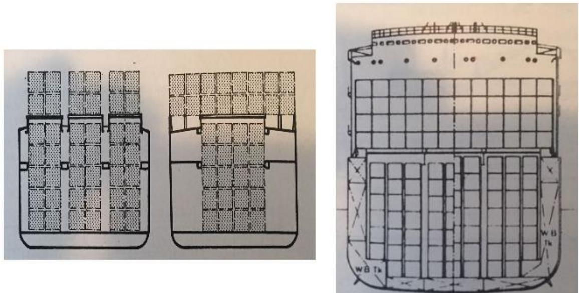
**Slika 13.Slaganje kontejnera u skladište pomoću vodilica [2]**
