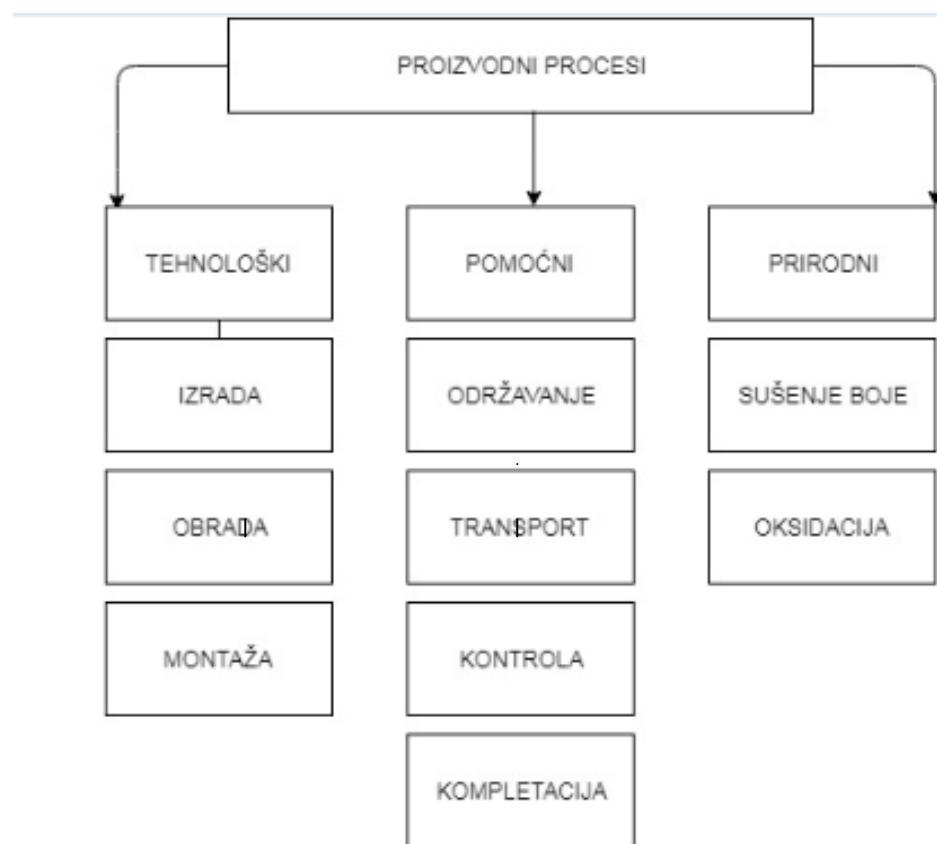
Slika 1. Proizvodni procesi u brodogradnji [1]
