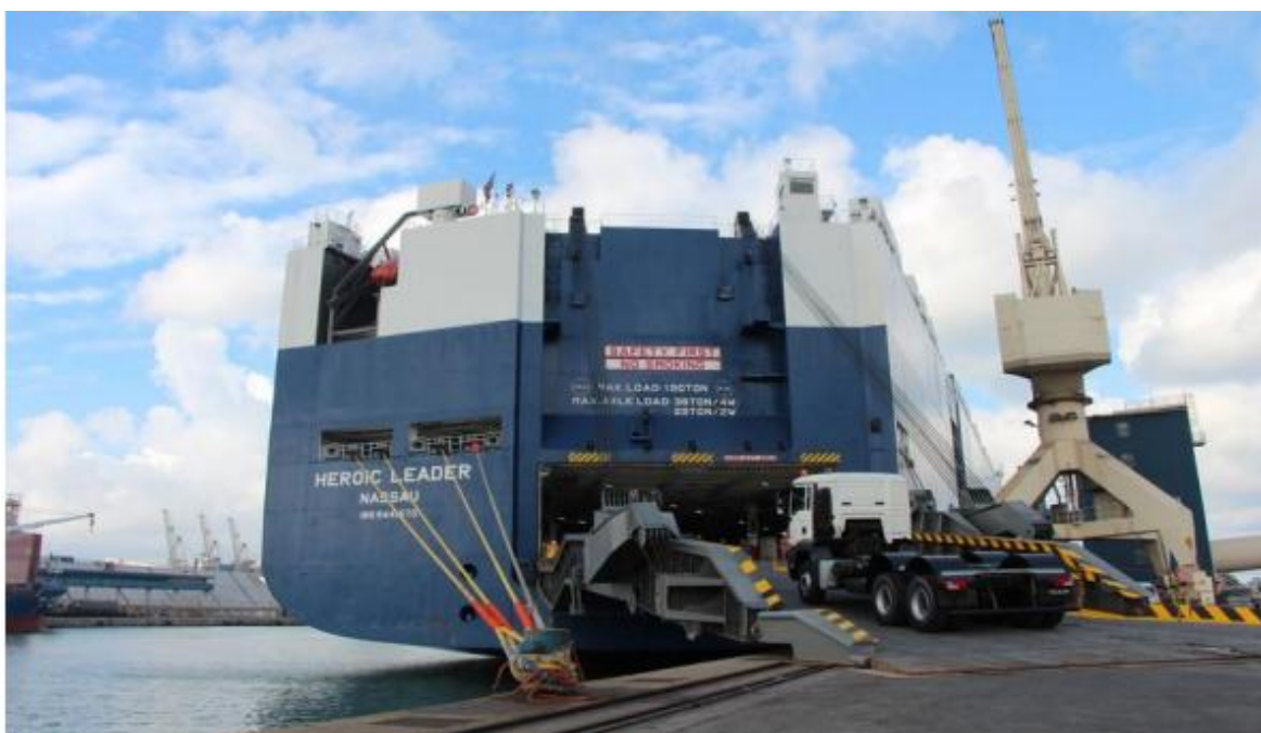
Slika 34. Otklonjena krmena rampa ro-ro broda [14]
