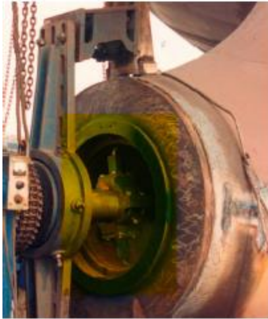
Slika 10. Stroj za koso bušenje [1]
