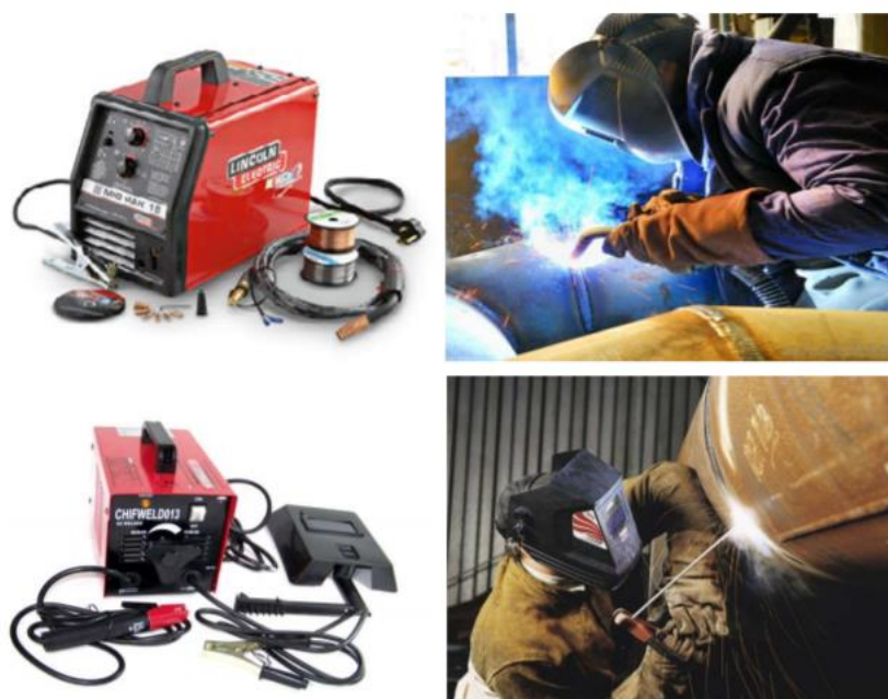
Slika 10. Aparat za zavarivanje MIG postupkom (gore lijevo) i postupak zavarivanja čelične cijevi (gore desno) [14]
