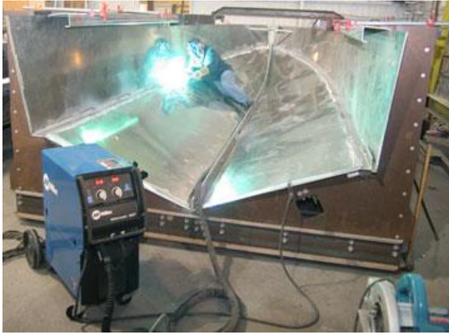
Slika 27. Zavarivanje trupa broda MIG postupkom (deblji limovi)
