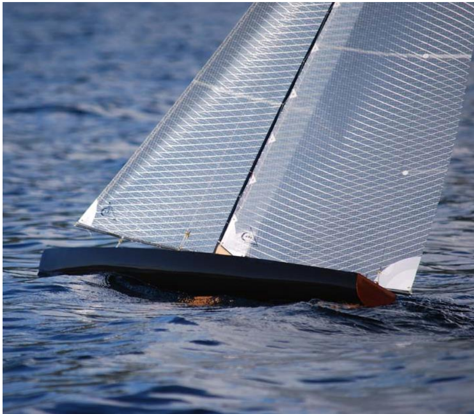
Slika 63. Model jedrilice sa karbonskim trupom
