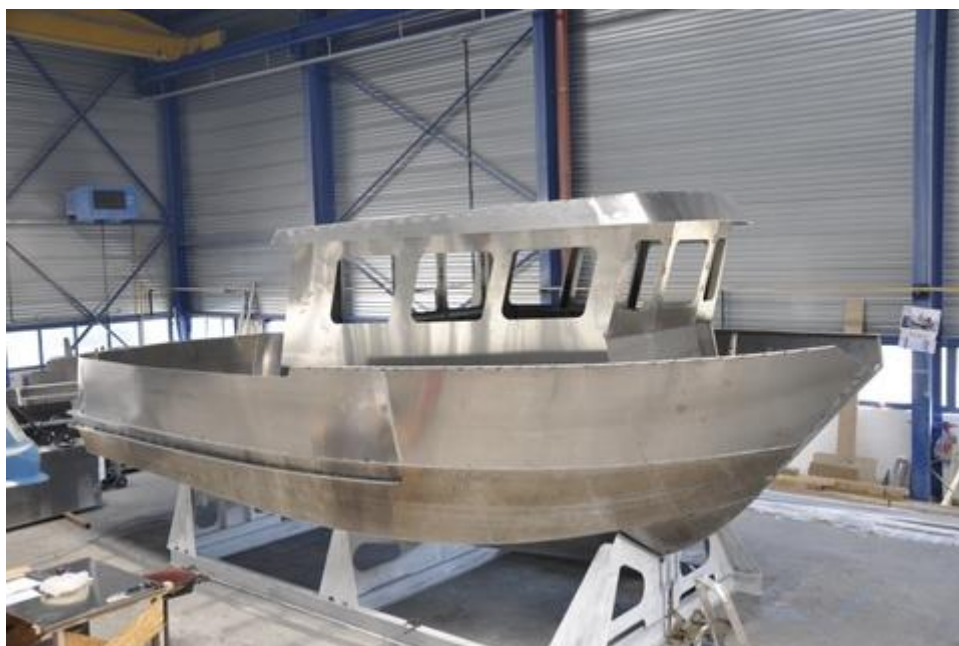
Slika 20. Zavareni aluminijski trup s nadgrađem
