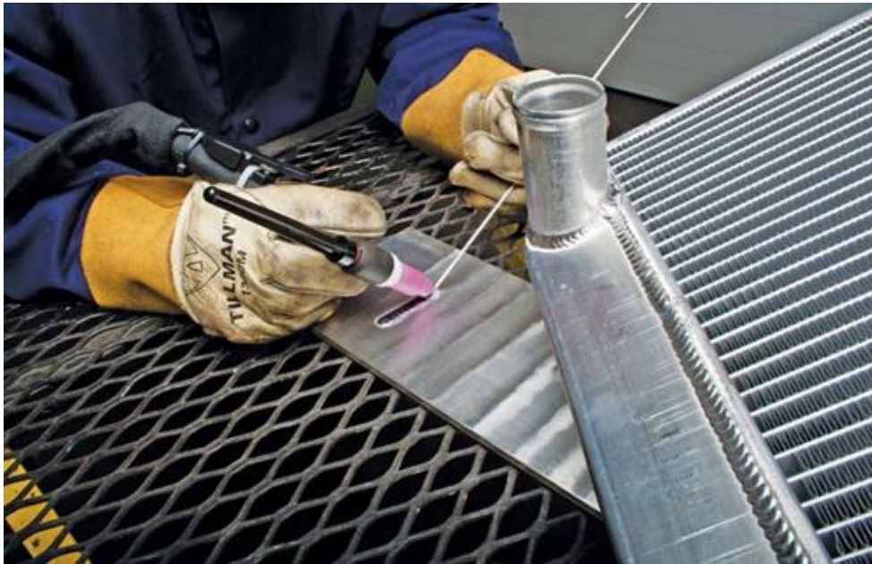
Slika 26. Postupak zavarivanja TIG postupkom (tanki limovi)
