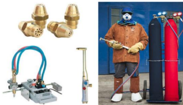
Slika 9. Pripor i boce sa plinom i kisikom za plinski rezač [14]
