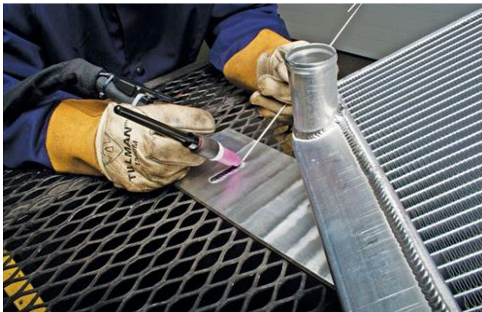
Slika 26. Postupak zavarivanja TIG postupkom (tanki limovi)
