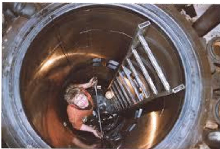
Slika 33. Mjerenje istrošenja košuljice motora mikrometrom [6]
