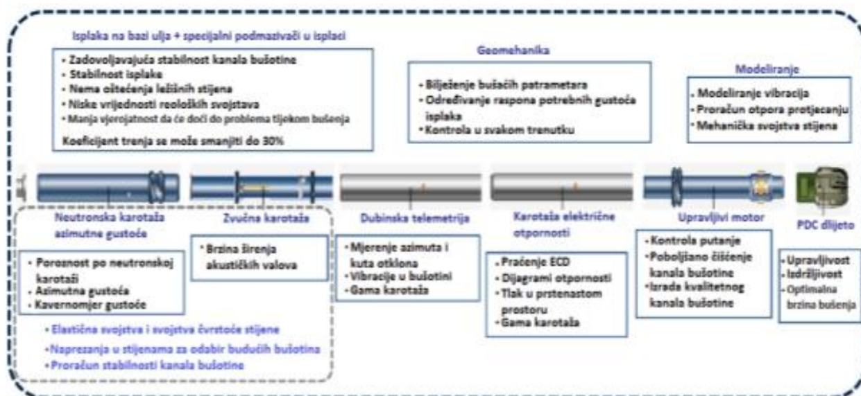
Slika 55. Sklop za usmjereno bušenje s osnovnim komponentama [5]
