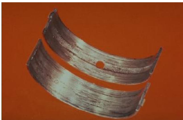
Slika 29. Adhezijsko trošenje do aluminijskog sloja [6]
