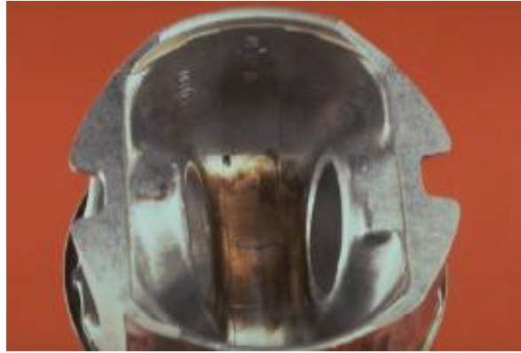
Slika 18. Diskoloracija uzrokovana nedovoljnim hlađenjem klipa [7]
