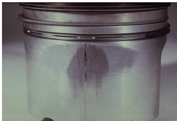
Slika 21. Adhezijsko trošenje kod hladnog starta [7]
