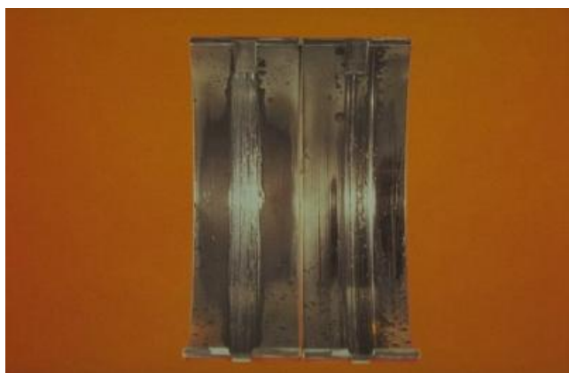
Slika 31. Abrazivno istrošenje uzrokovano tvrdim česticama [6]
