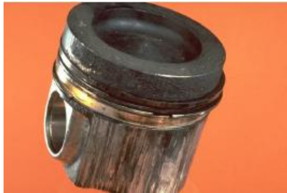
Slika 22. Trošenje prstenova zbog loše kvalitete ulja [7]
