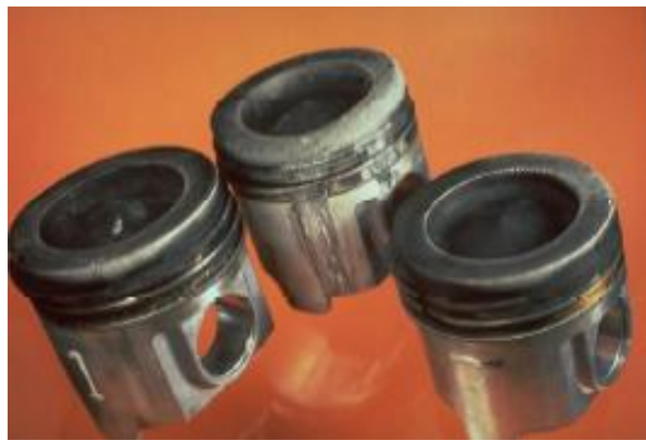
Slika 20. Prikaz erozije glave klipa koja rezultira zaribavanjem [7]
