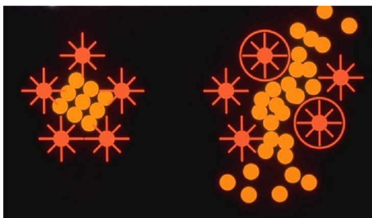
Slika 3. Promjena kristalne strukture voska usljed korištenja aditiva [5]
