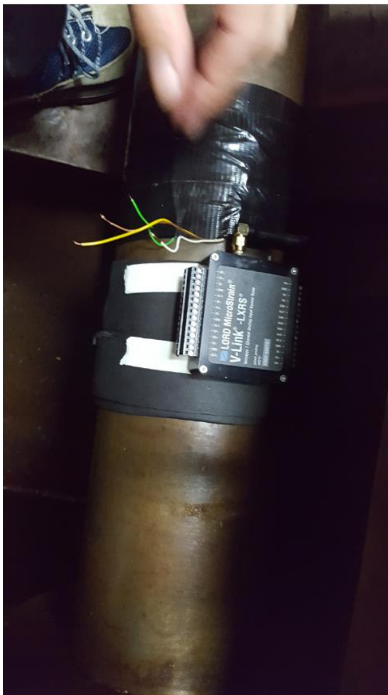
Slika 22. Prikaz pričvršćenja senzora na vratilni vod [izvor Luka Bugarin]
