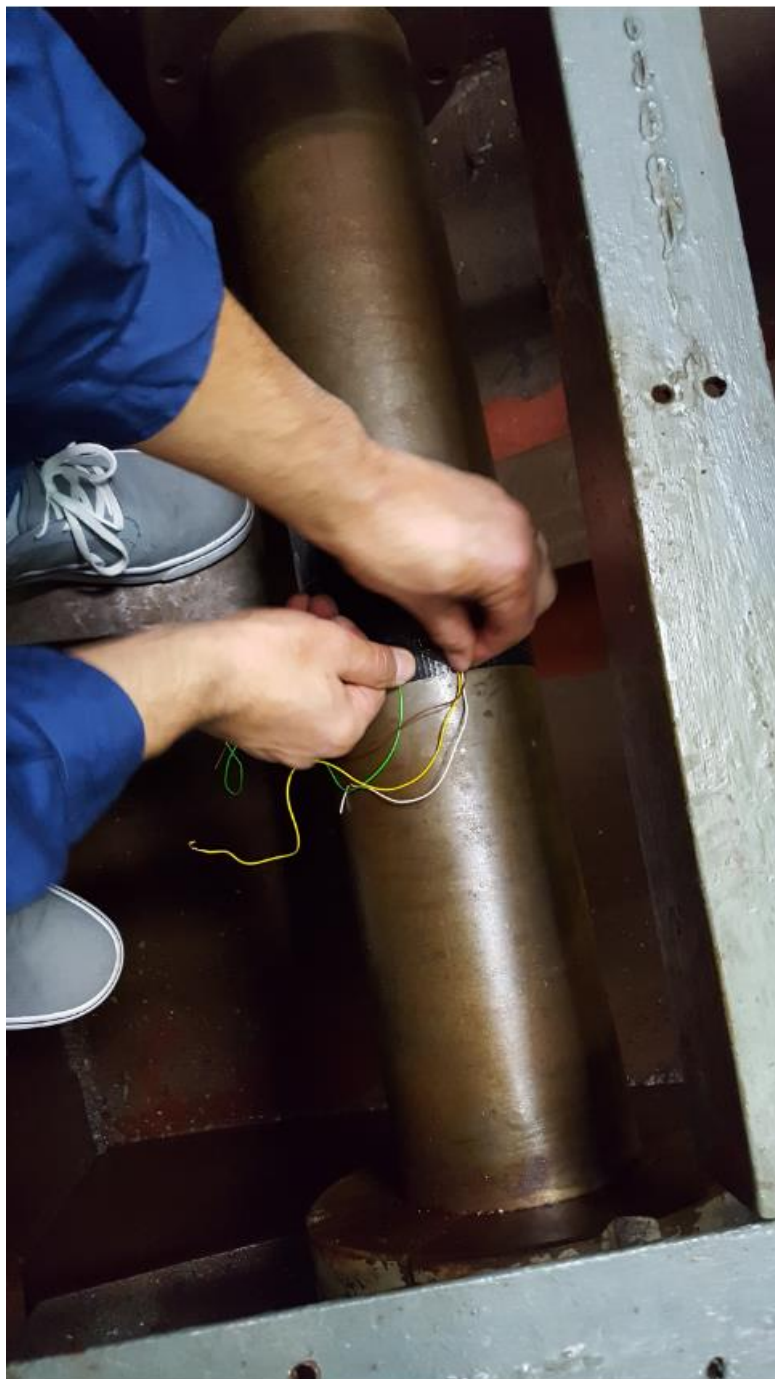
Slika 21. Prikaz tenzometarskih traka sa zalemljenim žicama nakon pričvršćivanja izolir trakom [izvor Luka Bugarin]
