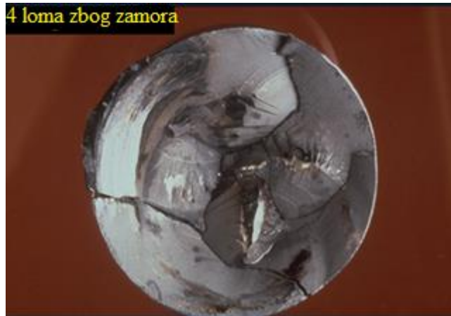
Slika 53. Lom zbog zamora uslijed torzije [20]
