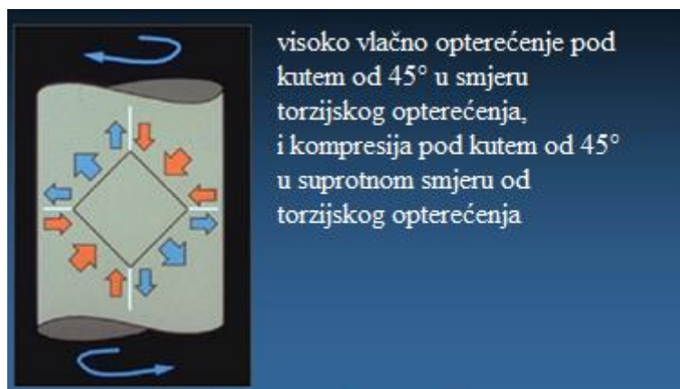
Slika 50. Shema opterećenja na torziju [20]
