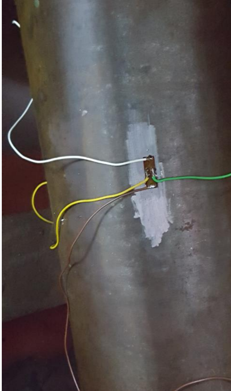
Slika 20. Izgled tenzometarskih traka nakon zalemljenih žica [izvor Luka Bugarin]
