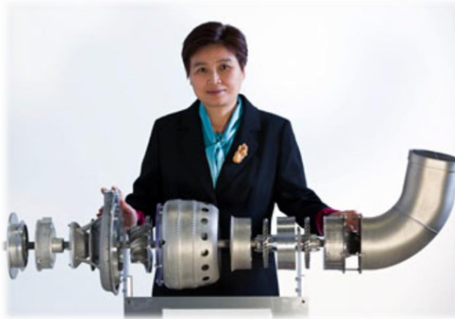
Slika 30. Mlazni motor izrađen 3D tehnologijom tiska [4]
