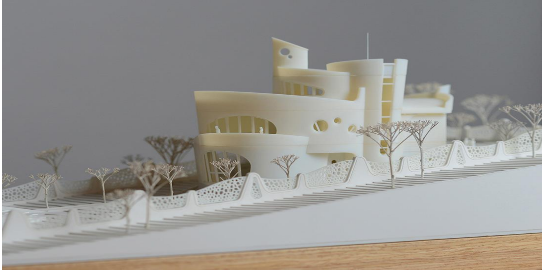
Slika 7. Model arhitektonskog dizajna – izravni tisak sa CAD projekta[10]
