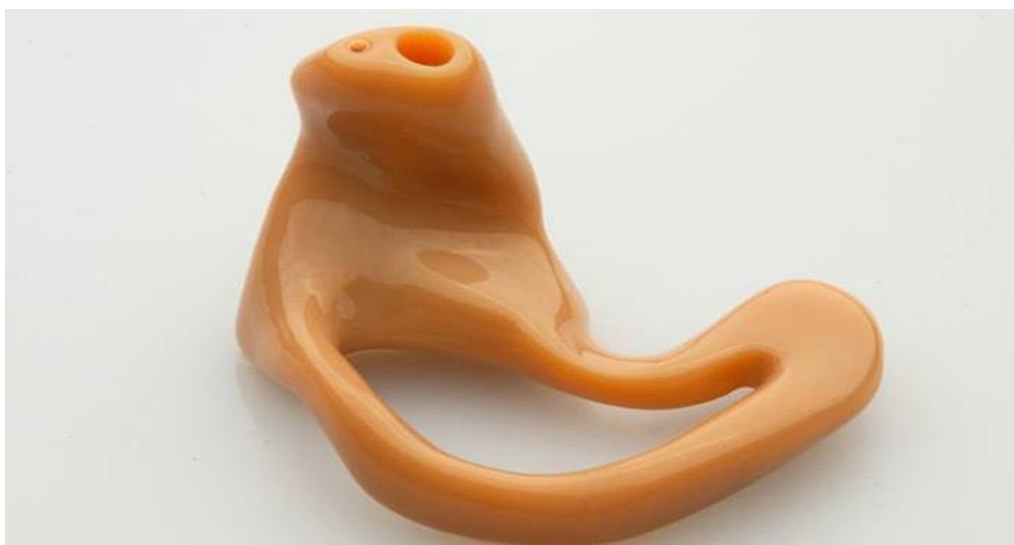
Slika 4. 3D tisak modela slušnog aparata[10]
