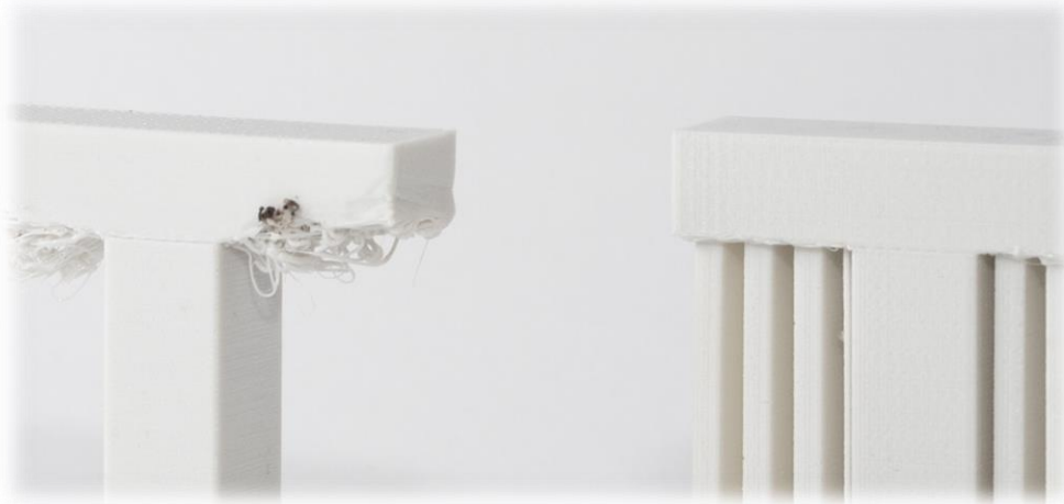
Slika 43. Primjer potrebe za konstrukcijom potpore [10]
