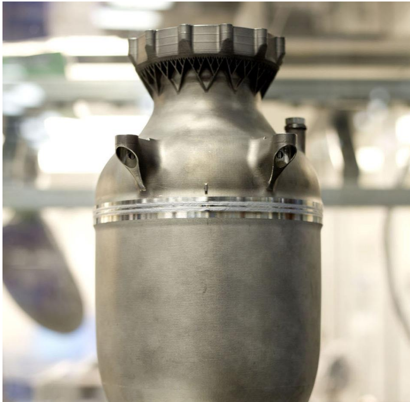
Slika 6. Komora motora tiskana 3D tehnologijom [10]
