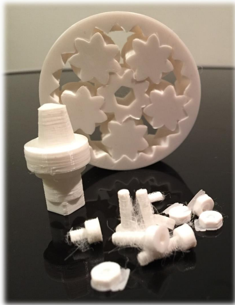
Slika 46. Modeli tiskani FDM tehnologijom 3D tiska
