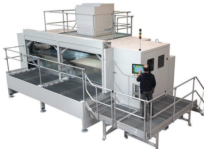
Slika 31. Veliki Voxeljet 3D pisač koji koristi pijesak za stvaranje modela [4]
