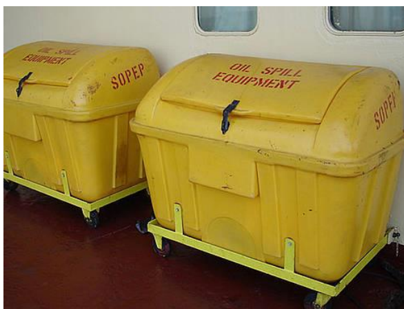
Slika 5. SOPEP oprema na brodu [18]
