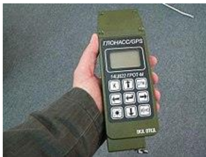
Slika 21. Vojni ruski kombinirani GPS/GLONASS prijemnik Izvor: [10]
