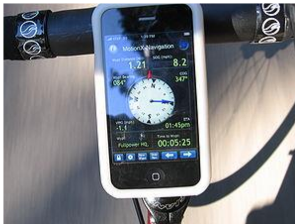
Slika 17. GPS prijamnik integriran u mobilnom telefonu Izvor: [9]
