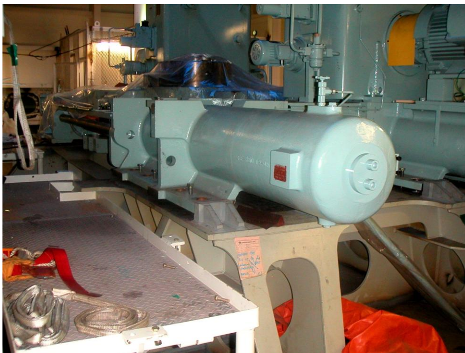
Slika 39. Prikaz hidrauličkog klipnog uređaja sa broda Tangguh Sago [5]
