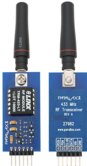
Slika 9. 433 MHz RF antena [1]
