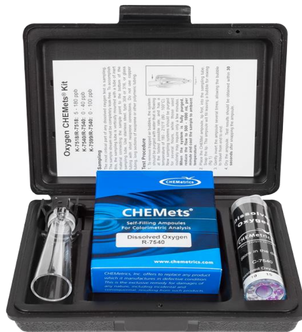
Slika 12. Pribor za mjerenje koncentracije slobodnog kisika u vodi brodskih generatora pare [11]
