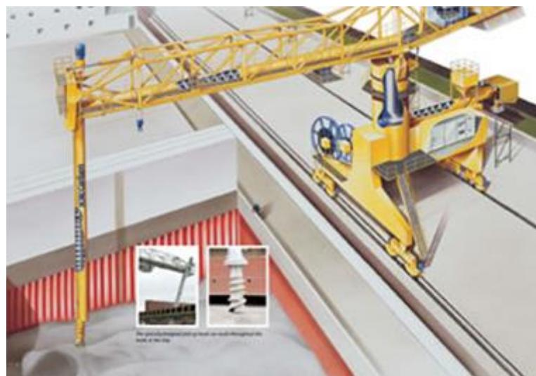
**Slika 13. Pneumatski tlačni transporter sa pužnicom [3]**
