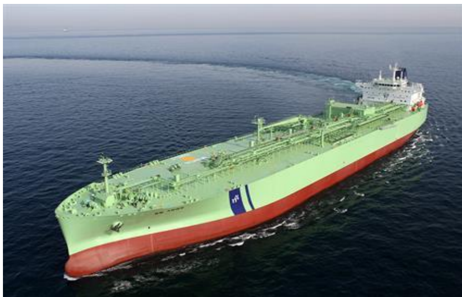
Slika 2. LPG brod za prijevoz polu rashlađenog plina [8]
