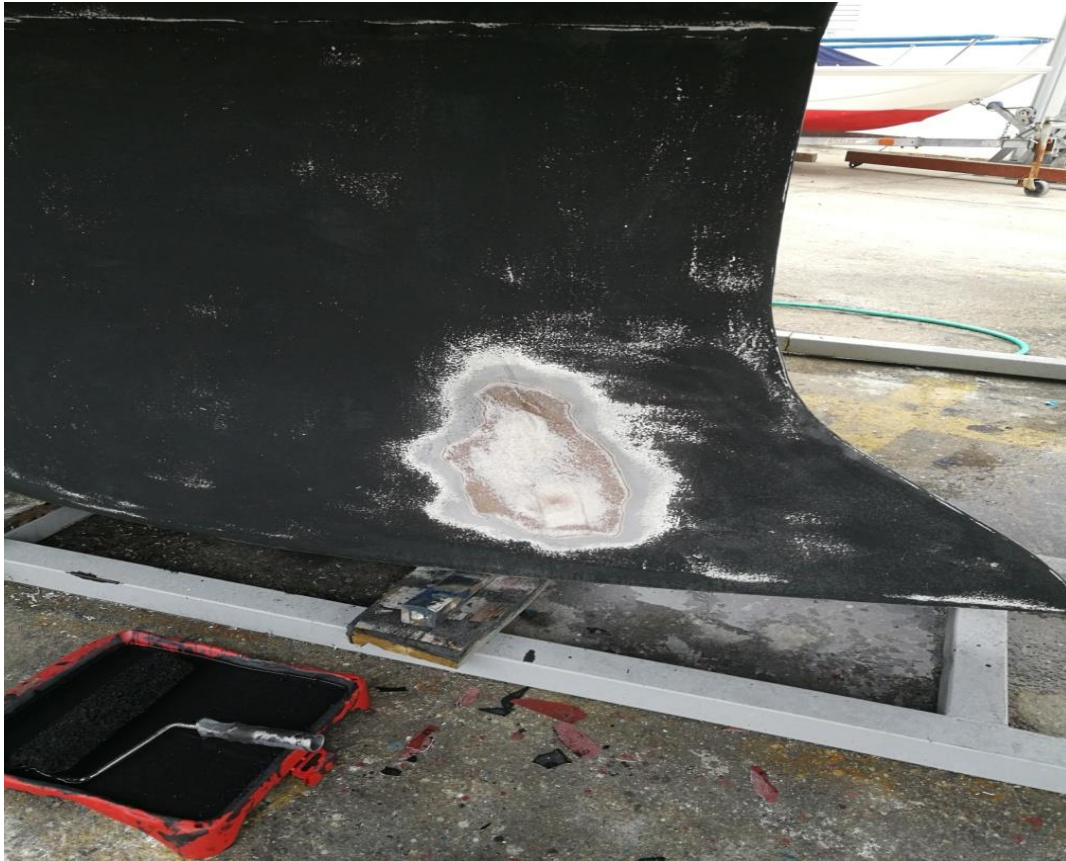
Slika 3. Saniranje oštećenja na kobilici
