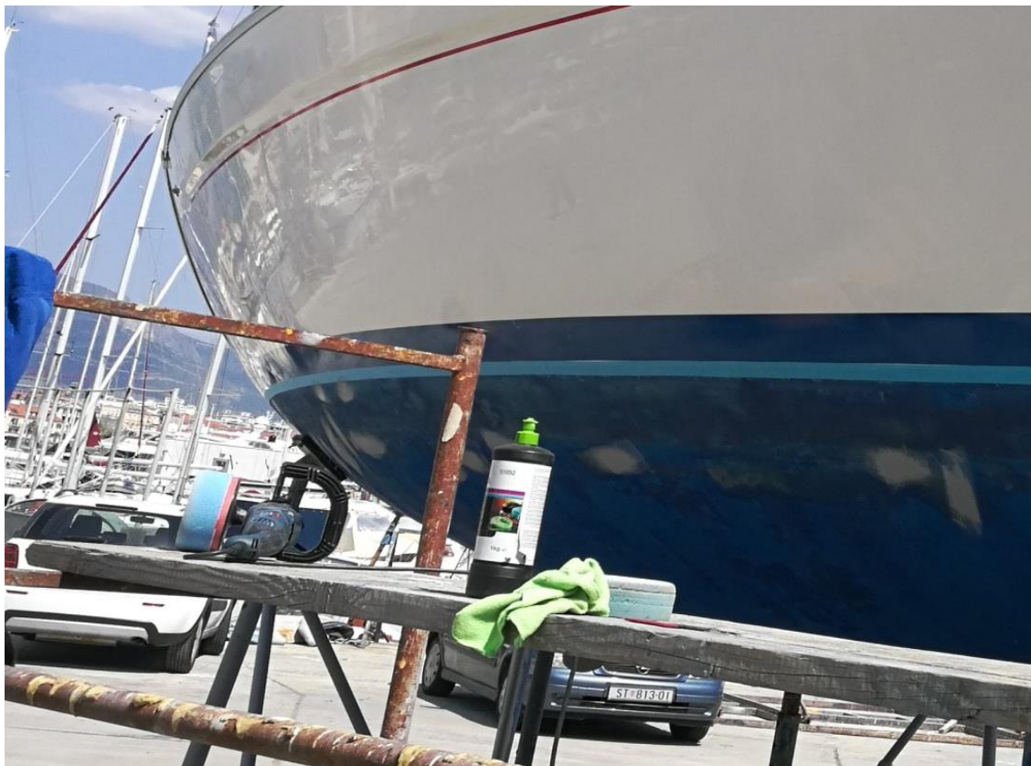
Slika 10. Poliranje bokova plovila
