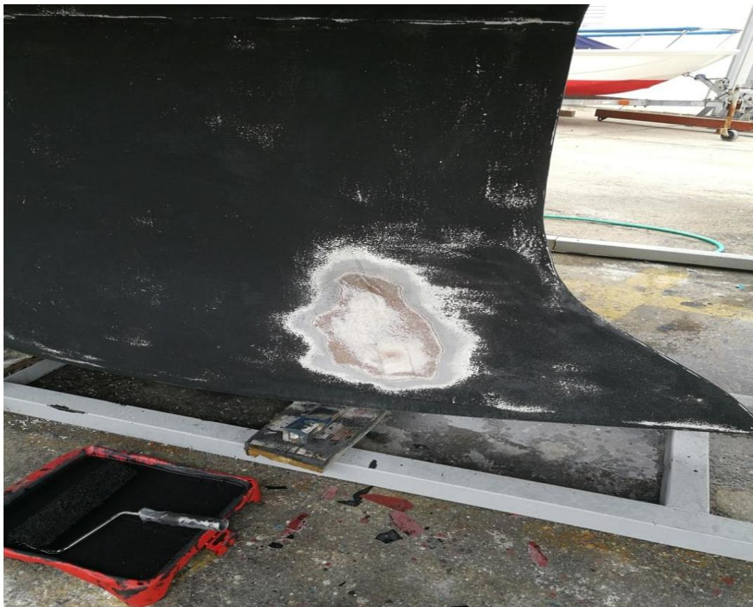
**Slika 3. Saniranje oštećenja na kobilici**
