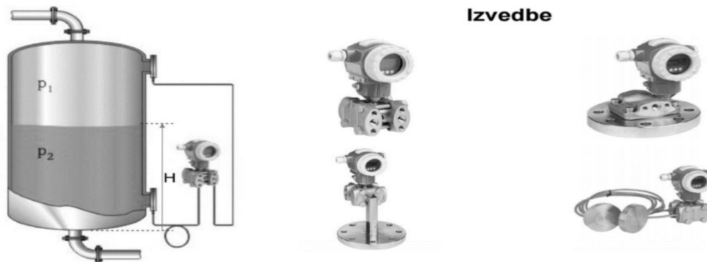
Slika 18. Mjerenje razine otvorenog spremnik [1]
