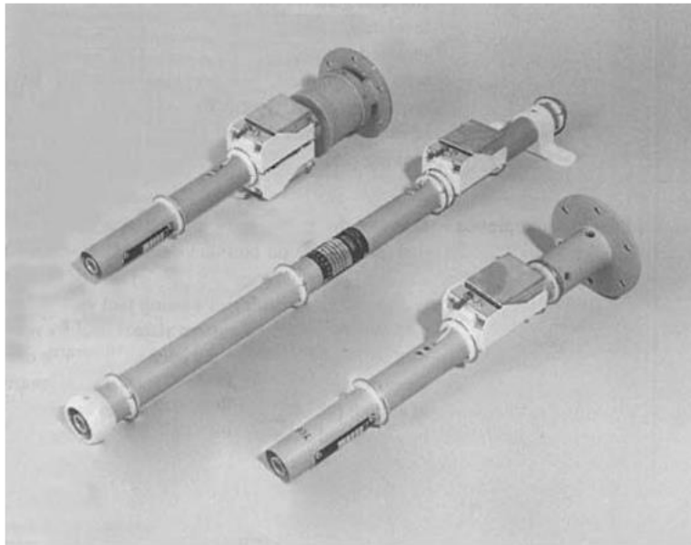
Slika 30. Kapacitivne sonde za mjerenje razine goriva u spremniku [20]
