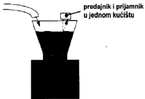
Slika 26. Lasersko mjerenje razine [1]
