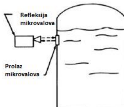
Slika 23. Radarski senzor razine [2]
