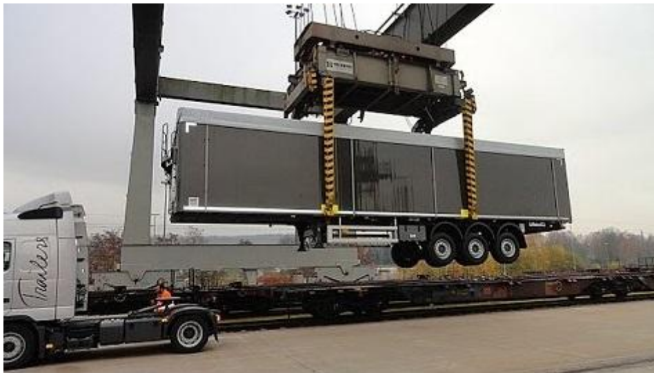
Slika 14. Vertikalni ukrcaj poluprikolice u Huckepack B sustavu [14]
