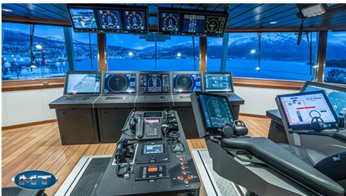
Slika 5. Upravljačka konzola DP sustava [20]
