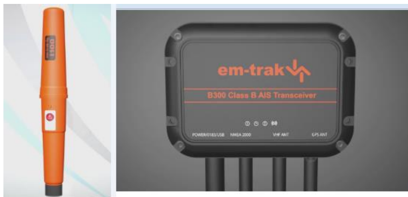
Slika 9. Modeli AIS odašiljača/prijemnika za različite tipove brodova [49]
