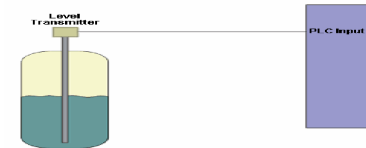
Slika 2.4. Primjer analognog ulaza [2]
